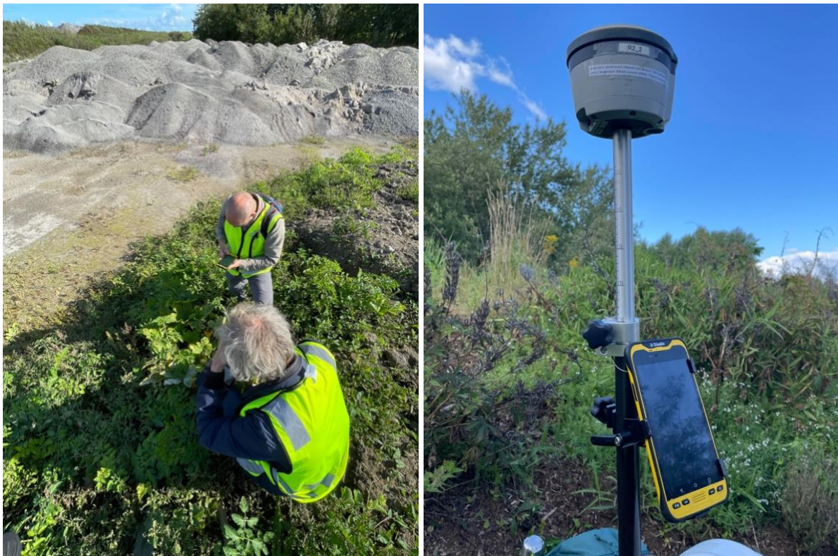
Figur 2: Artene ble identifisert av kartleggerne i felt. (venstre). Høypresisjons-GPS, Trimble R2, og tilhørende Trimble TDC600 mobil brukt i kartleggingsarbeidet (høyre). Foto: Pauline Marie Søndena.
