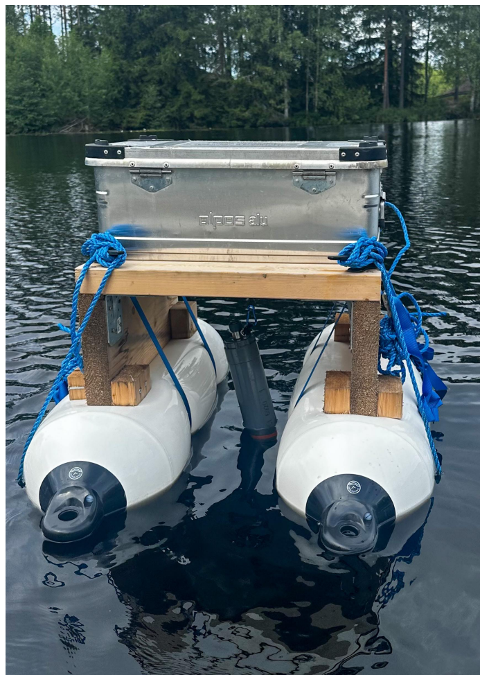
Figur 6: "vertical profiler", ankret fast i midten av Kutjern. Her ble alle vannprøver tatt. YSI 6920 (multiparametersonde) er koblet under (bilde tatt under feltarbeid, Kutjern 29. juni 2023).
