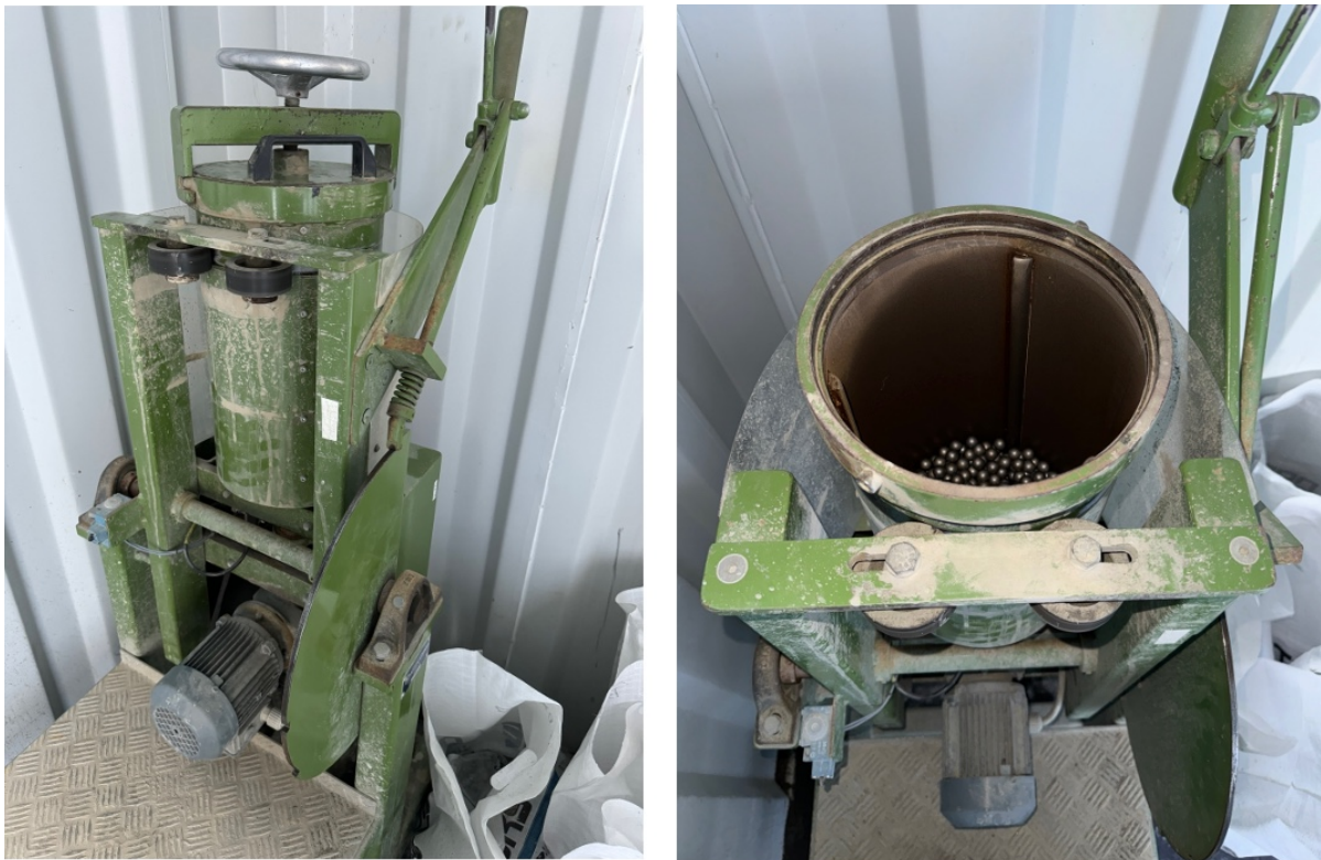
Figur 3.7: Kulemøllemaskin som brukes i metoden med stålkuler oppi. Foto: Heidrun Sande
