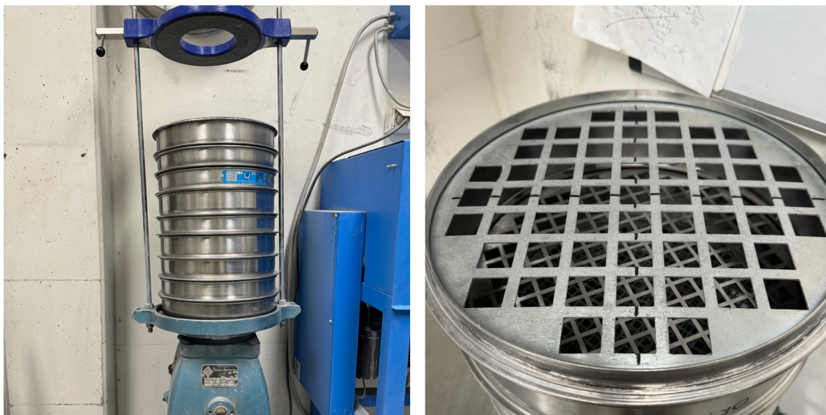
Figur 3.6: Siktemaskin og siktesett til sikteanalyse. Foto: Heidrun Sande
