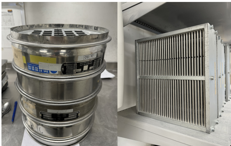
Figur 3.10: Prøvingssikter (venstre) og stavsikter (høyre) til flisighetsanalyse. Foto: Heidrun Sande
