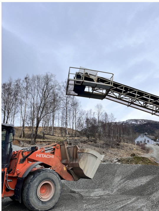
(c) Massen transporteres fra VSI, via transportbånd, ned i en skuff hvor prøven tas.
