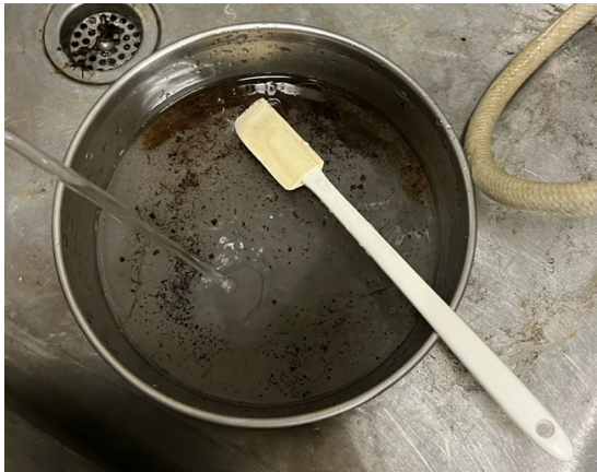
Figur 13: Måling av fiberinnhold med sikt og slikkepott.
