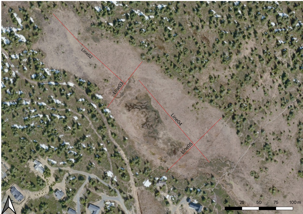
Figur 8: Oversikt over georadartransektene i Heståmyra. Line02 og Line04 går langs myra, mens Line03 og Line05 krysser myra på langs.
