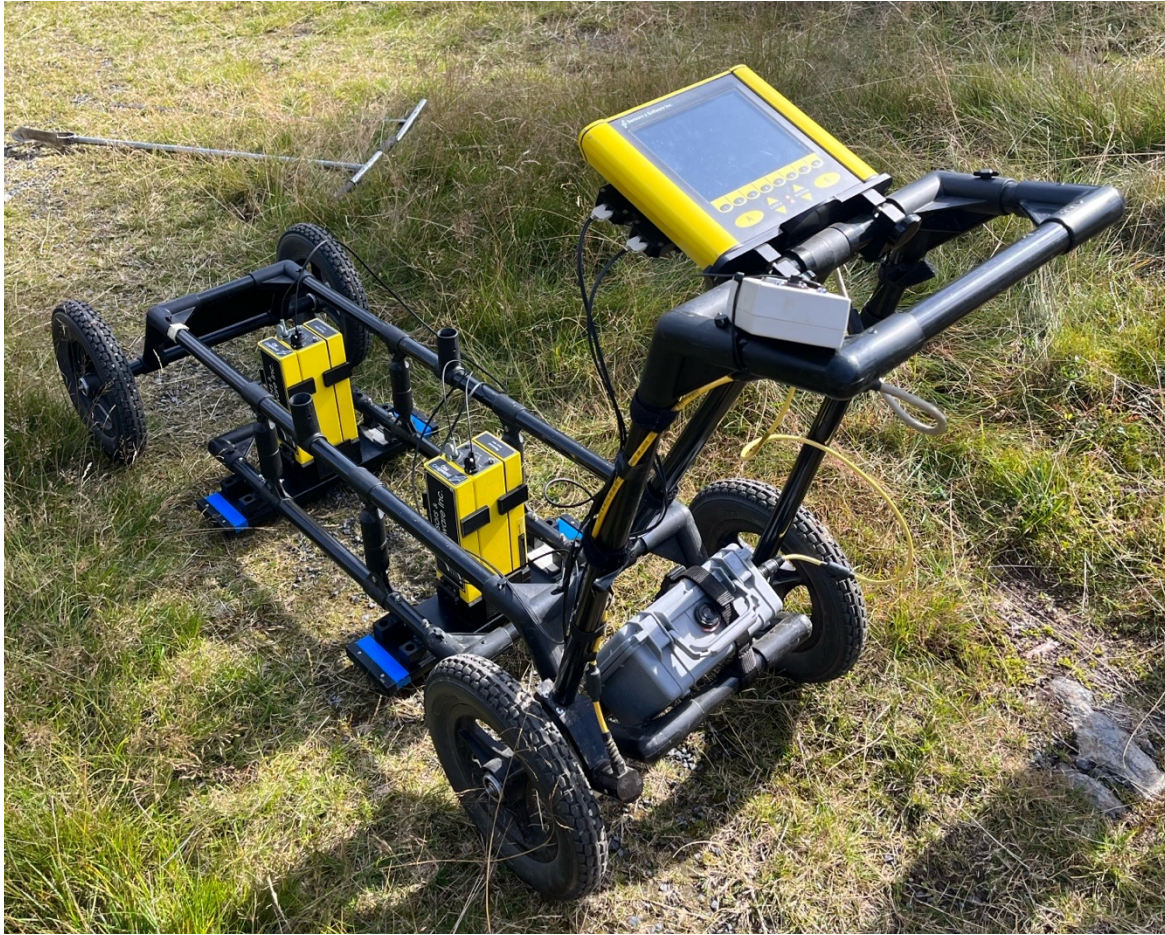
Figur 7: Georadaroppsett. Transmitteren er montert foran på en SmartCart, mens mottakerantennen er plassert bak senderen. Øverst ved håndtaket er den digitale videologgeren montert.
