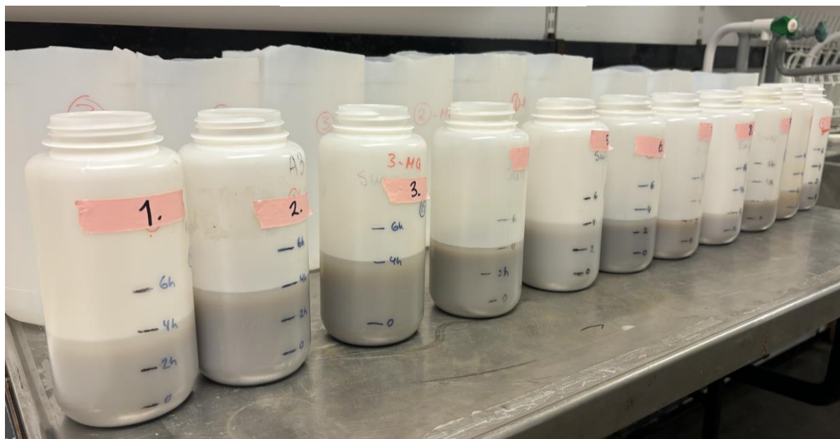
Figur 10. Flasker med gjørmevann som inneholder silt og leire, der silt sedimenteres etter valgt tid (2, 4 eller 6 timer). På bildet er valgt tid 4 timer. Vannet som inneholder leire, ble pumpet over i de større beholdere i bakgrunnen (foto: Jennifer Holmelid).
