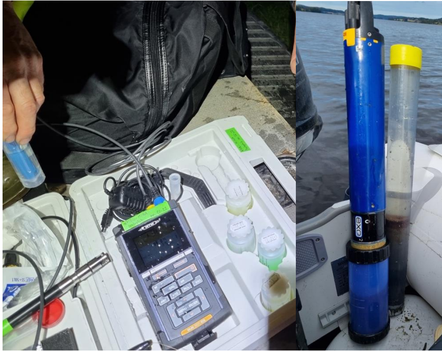
Figur 6. T.V.: Multimeter WTW 3410 og buffer kalibrering av elektroden. T.h.: EXO-2 sonde og en sedimentkjerne. Foto: Thronnd Oddvar Haugen.
