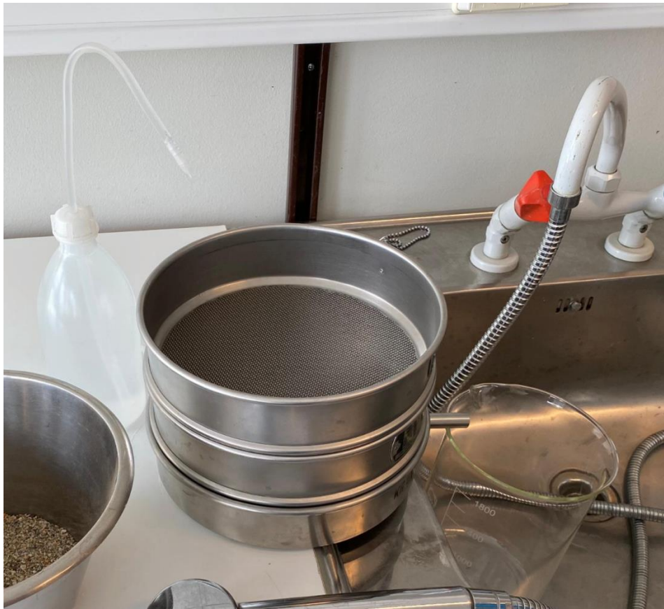
Figur 9. Kornfordeling ved bruk av sikter. Øvre sikt har en maskevidde på 1 mm, nedre sikt har en maskevidde på 63 \mu\text{m} , og en bunn brukes til å samle silt- og leirfraksjonen, som igjen samles i en større beholder (Ruther, 2022).
