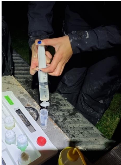
Figur 5. Filtrering av vannprøver med sprøytefilter på 0.45 \mu\text{m} . Foto: Thrond Oddvar Haugen.
