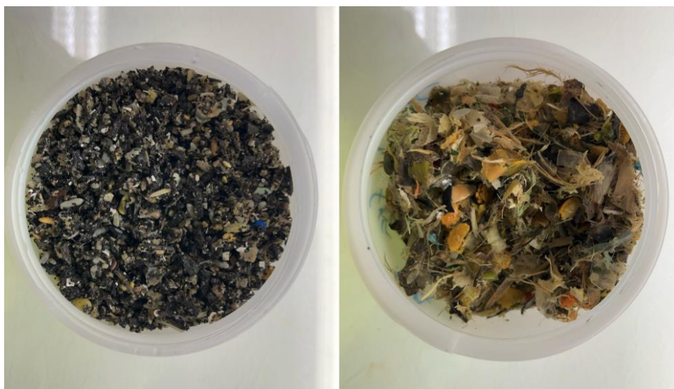
Figur 9: Prøve-digel fra sikterest. Til venstre er sand-rejekt fra anlegget, til høyre er plast-rejekt fra anlegget. Prøvene ble tatt 23.04.24. Foto: Emilio Alvarenga.
