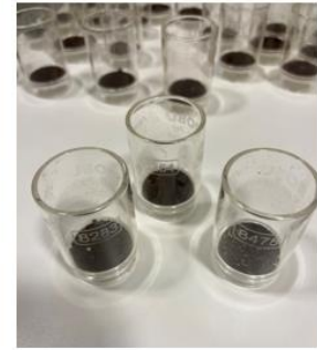
Figur 5. Bilder av Ligninekstraheringsprosessen. 1: Ekstraherte prøver, 2: Prøver tilsatt 72% svovelsyre i vannbad, 3: Løsning overført til Schott flasker og tilsatt 28 ml destillert vann, 4: Filtre etter at løsningen ble filtrert igjennom, 5: Filtre til tork på 125°C i 1 time, 6: Filtre etter de ble tørket og veid.
