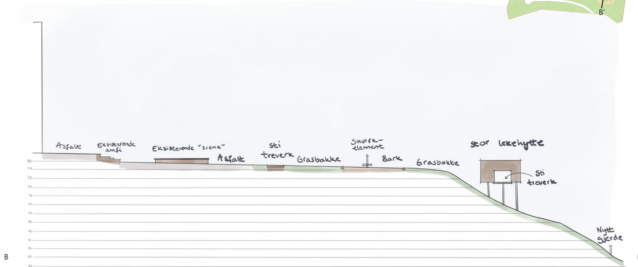
Snittet viser ny situasjon i sør, hvor eksisterende amfi og "scene" blir ivarettatt. Videre utvider vi område for tilgjengelig bruksareal og bygger sti i treverk som både går på bakkeplan og svever. 1:250/A3
