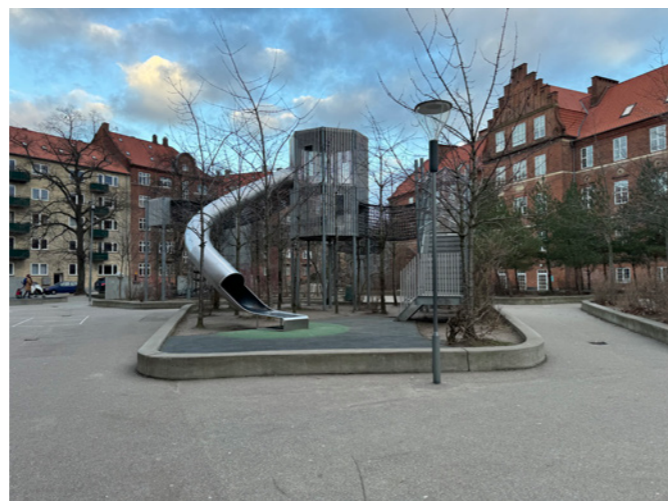
Amager Fælled skole i Danmark har flere gode kvaliteter. Det er derimot flere områder som er utilgjengelige på grunn av barrierer. Her er det benyttet helstøpt gummidekke i et område som ikke er tilgjengelig med rullestol i utgangspunktet. Flere av sonene har også opphøyde kanter og ingen mulighet å komme inn på.
