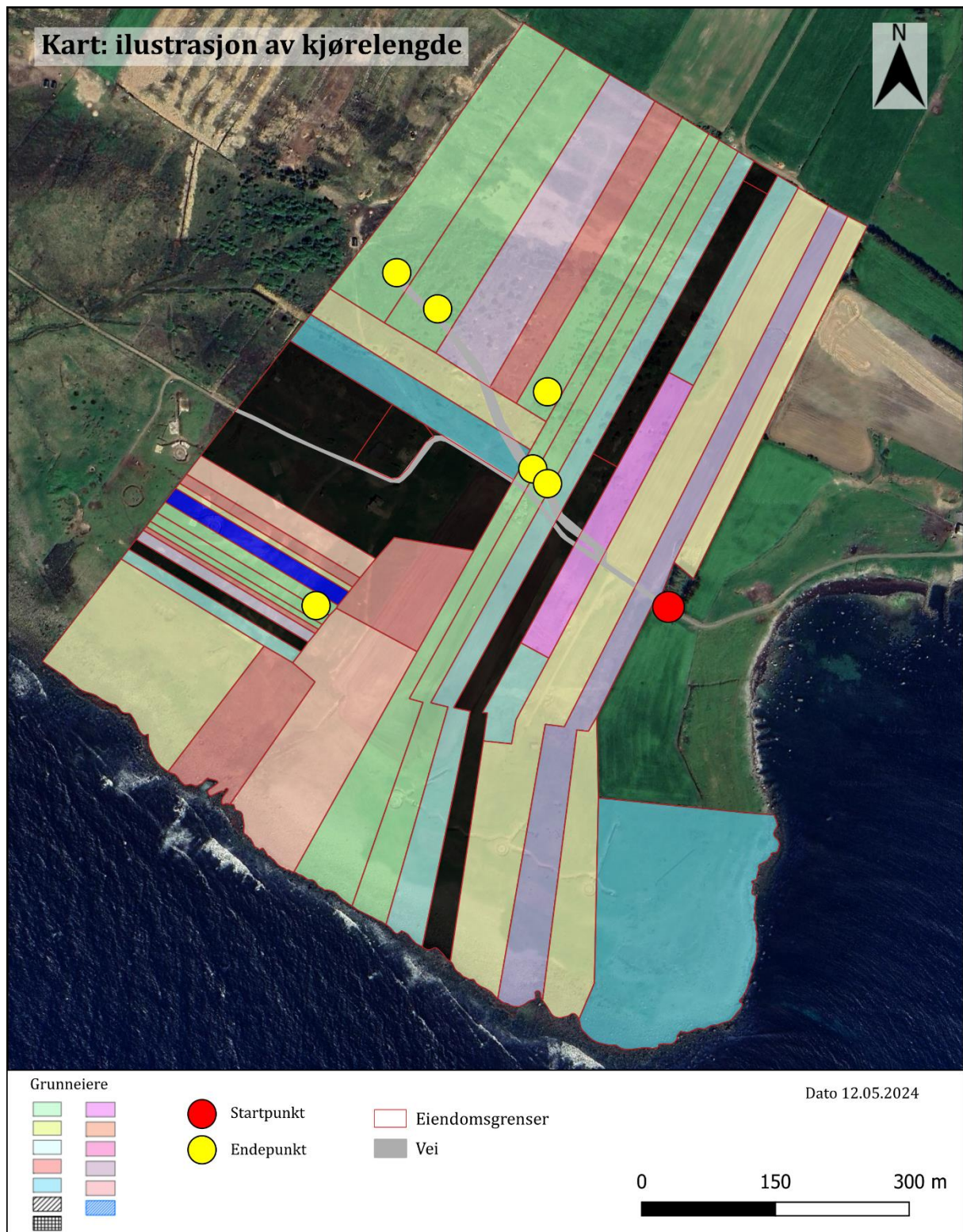
Figur 18. Selvprodusert kart som viser kjørelengde til grunneiere (grønn) sine teiger før jordskiftet i case I
