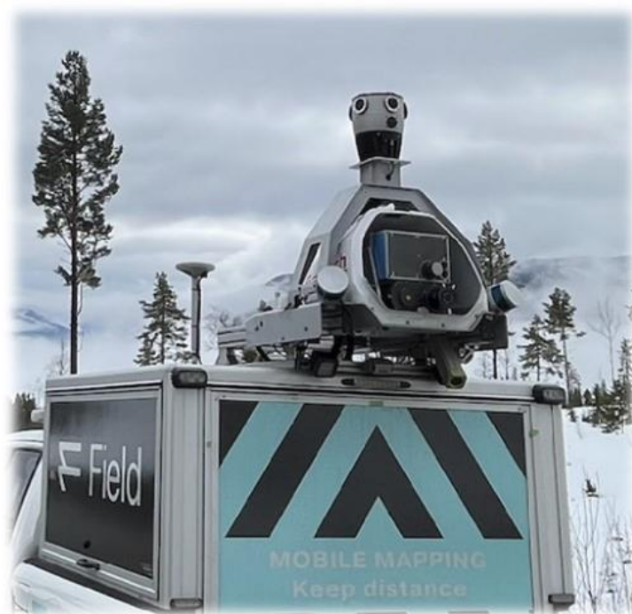
Figur 3.3: Bilde av rigg med kameraet Mosaic X og laserskanneren VLP-16 (Field, personlig kommunikasjon, 27. februar 2024).
