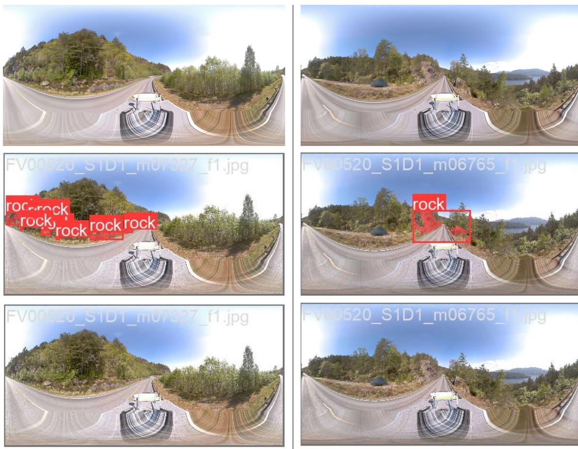
Figur 4.20: Eksempel på feilklassifisering av maskinlæringsmodellen
