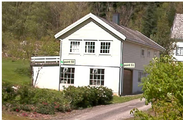
Figur 3.9: To markerte hushjørnet i Agisoft Metashape som er brukt til skalering av modellen.
