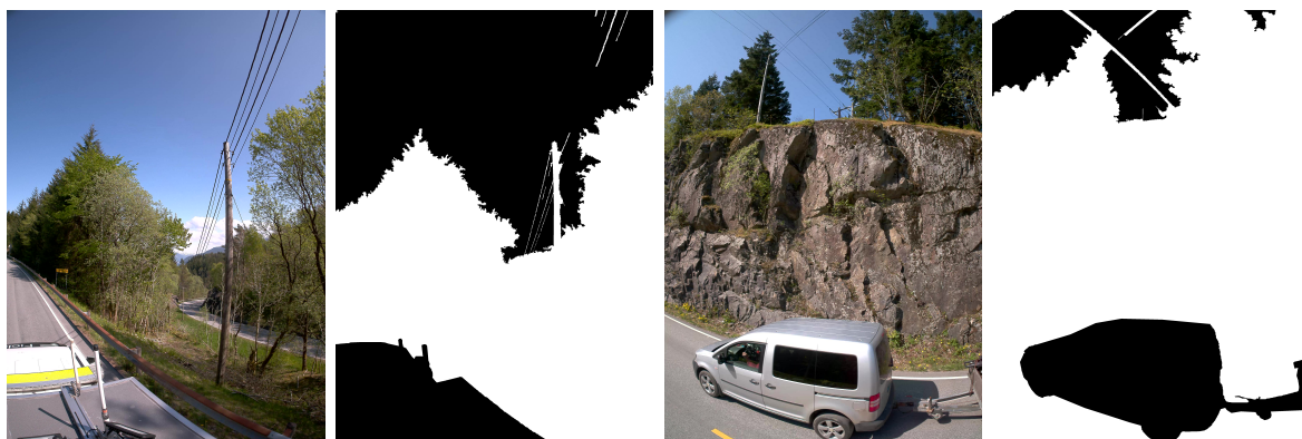
Figur 3.7: To bilder med tilhørende binær maske, hvor hvitt beholdes i bildet.
