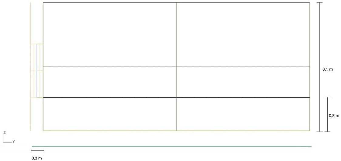
Figur 10 viser modellen fra siden med høyde på klasserommet og referansehøyden for målingsflaten.
