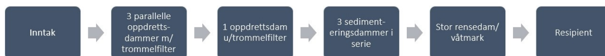
Figur 3.3: Forenklet flytskjema for renseprosessen på Noraker Gård. Trommelfil- teret er kun i bruk om sommeren.
