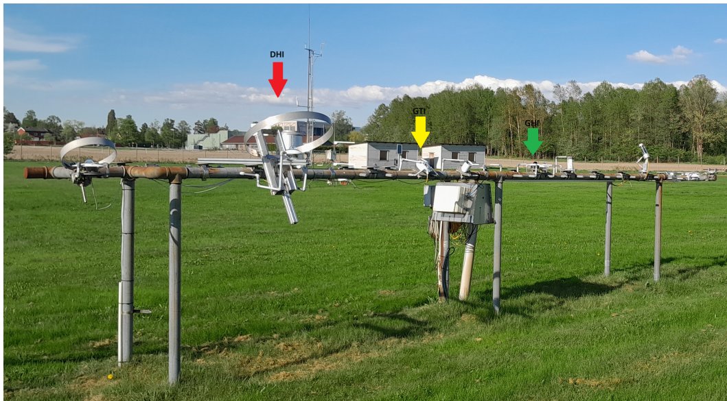
Figur 4.1: Måleoppsett på Søråsjordet for irradiansmålinger. Pyranometeret brukt for målinger av DHI er markert i rødt, for GTI i Gult og GHI i grønt.
