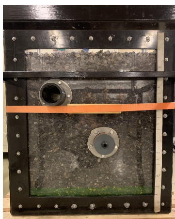
(a) Visuell fordeling av uranin i grøfta på dag 0.
