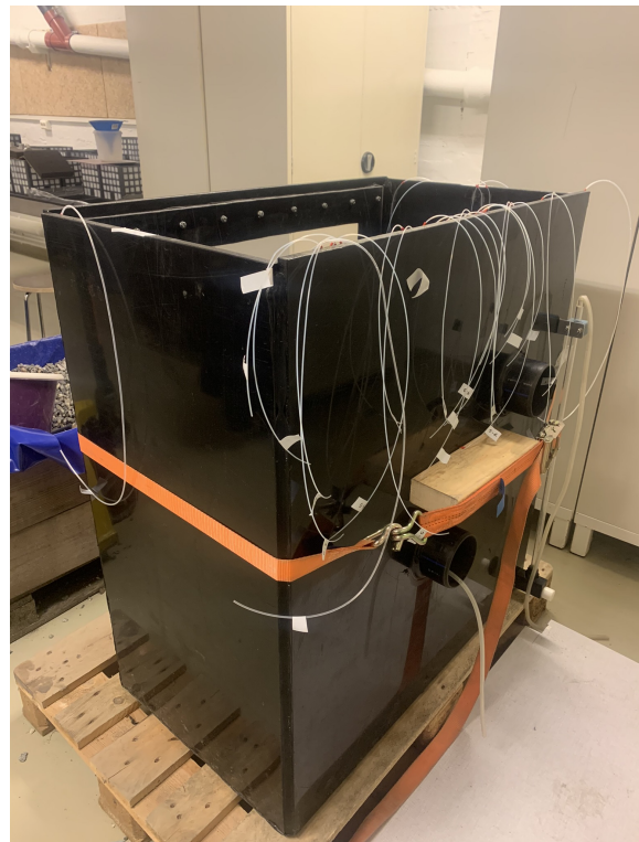
Figur E.2: Grøftekassa med slanger til prøvetaking. Slangane er markert med nummer i samhøve med Figur 2.2 og 2.3.
