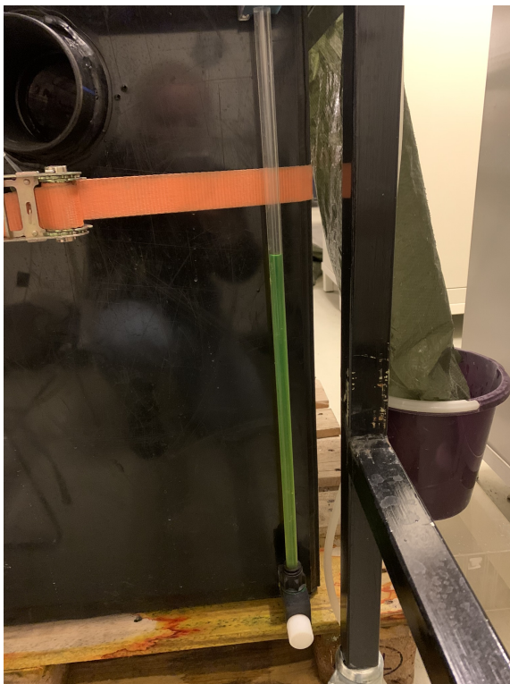
Figur E.5: Stigerør som syner vassnivået med uraninkonsentrasjon i grøfta. I botn av grøftekassa er det plassert eit tappingspunkt.
