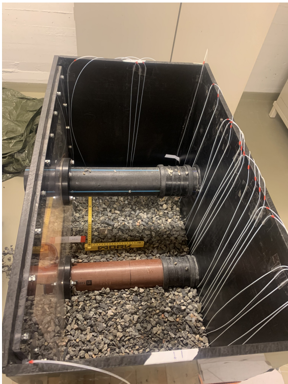
Figur E.1: Nedlegging av slanger til prøvetaking. Slangane vart ført ut til kanten av grøftekassa og opp langs veggen. Det vart nytta tommestokk for å måle opp plassering av punktet.
