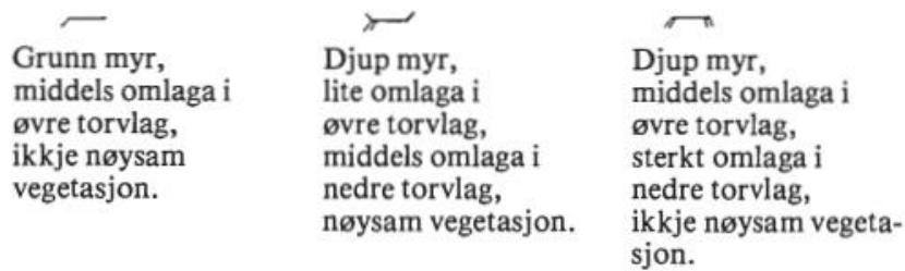
Figur 2.1: Eksempel på bruk av myrkosten. Figuren gir informasjon om myrens dybde, vegetasjon, torvlag, osv. (Einevoll, 1980).
