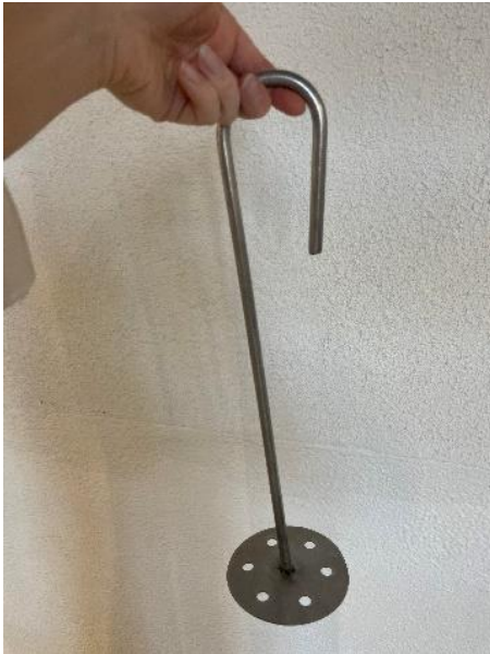
Figur 12. Rørepinne (diameter=7,5 cm) benyttet til å røre opp rømmekoagel etter fermentering. Foto: Hilde Hamremoen Tørud
