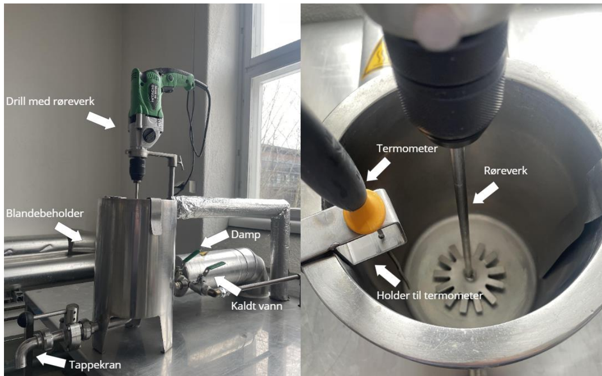
Figur 11. Hjemmelagd bordmikser/pasteur med tilkoblet tappekran, røreverk og temperaturregulering benyttet på pilotanlegget (KBM, NMBU). Foto: Hilde Hamremoens Tørud
