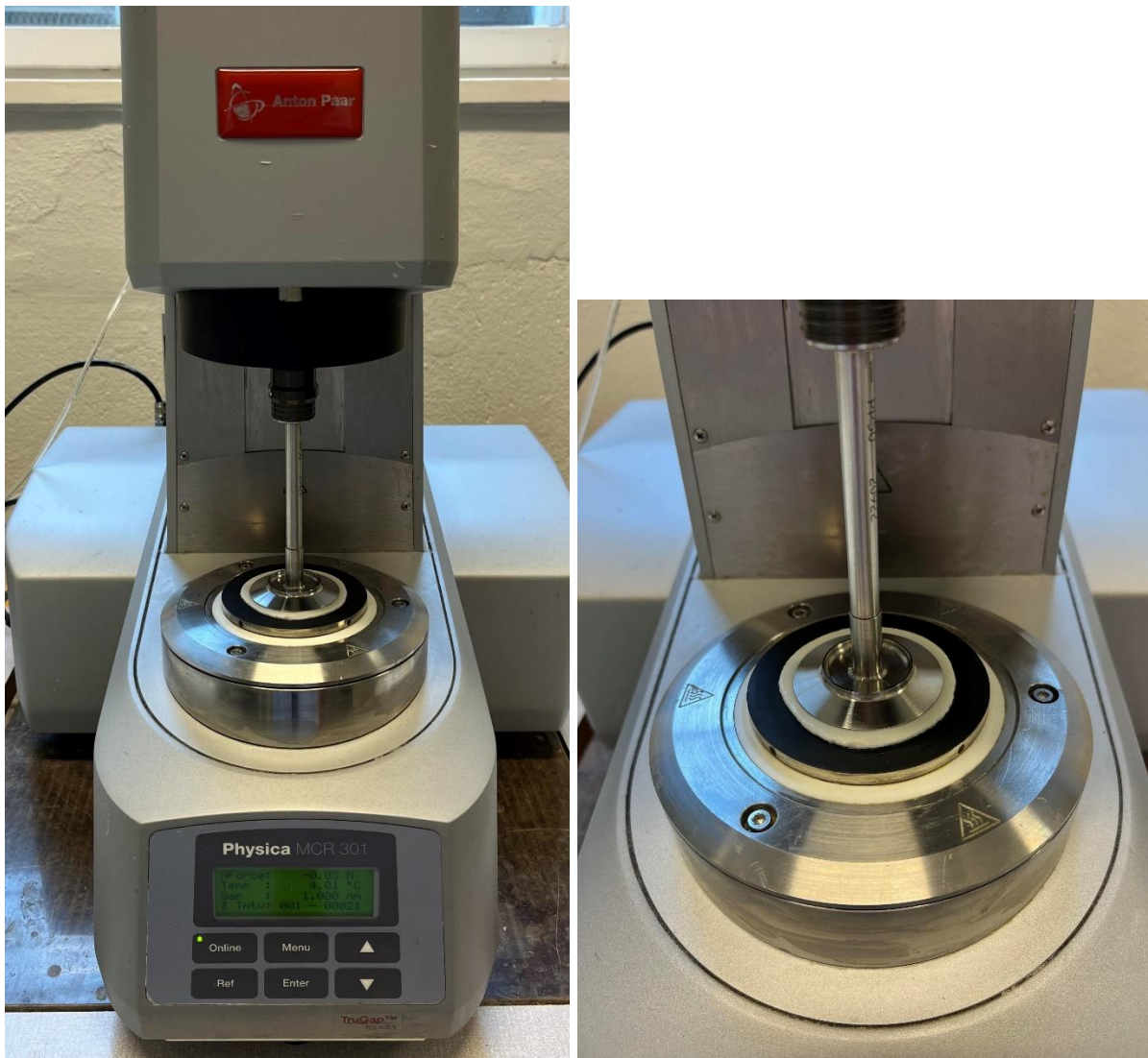
Figur 15. Instrument med probe (PP50) og prøve under reologimålingene.
