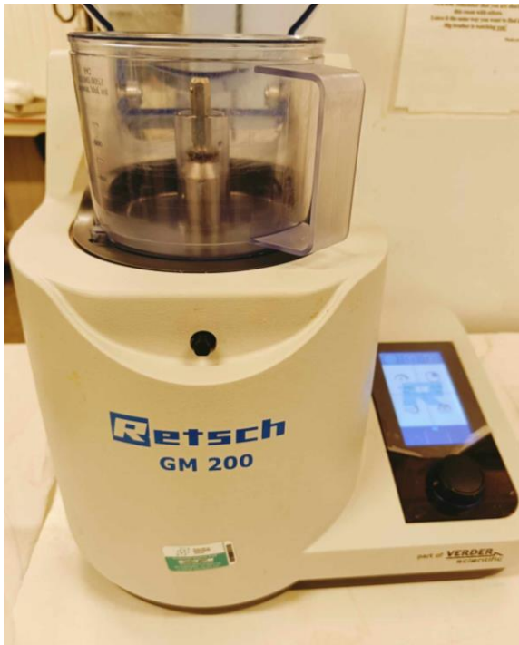
Figur 14 Knivmølle Grindomiks GM 200 som ble brukt til kverning av fiskematerialet.
