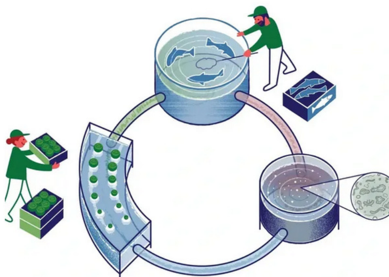
Figur 1:HydroMagic Farms (u.å.) Prinsipp for et lukket akvaponisystem med fisk, bakterier og planter. Tilgjengelig fra https://hydromagicfarms.no/v%C3%A5r-l%C3%B8sning (lest 20.01.2024)
