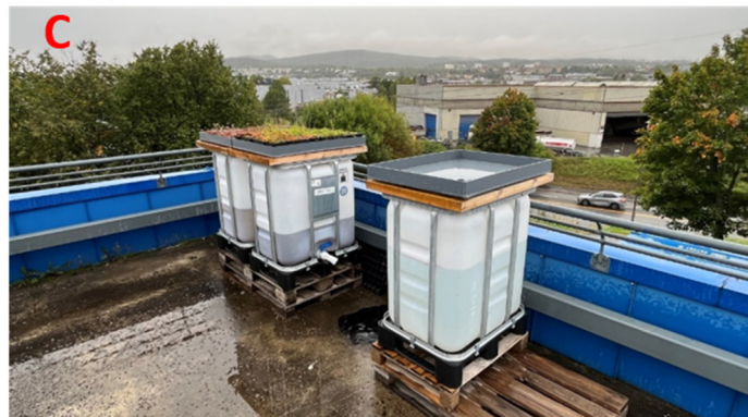
Figur 5: A) Kontainere med akvaponipiloten, akvakultur i bunn og hydroponi på toppen. B) Drivhus. C) Grønne tak og referansetak. Foto: Åsa Lagerstedt
