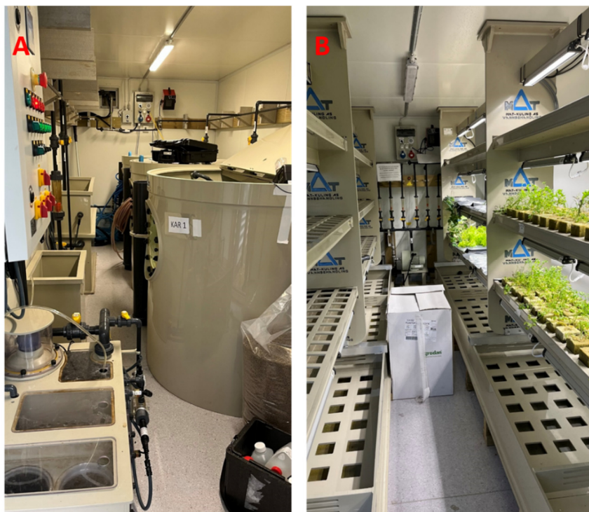
Figur 6: A) Fiskesystem med fisketanker til høyre og RAS-enhet nede til venstre i bilde. B) Plantesystem med forskjellige planter. Den nederste rekken består av deep water culture (DWC), mens de øvre hyllene består av nutrient film technique (NFT) Foto: Åsa Lagerstedt
