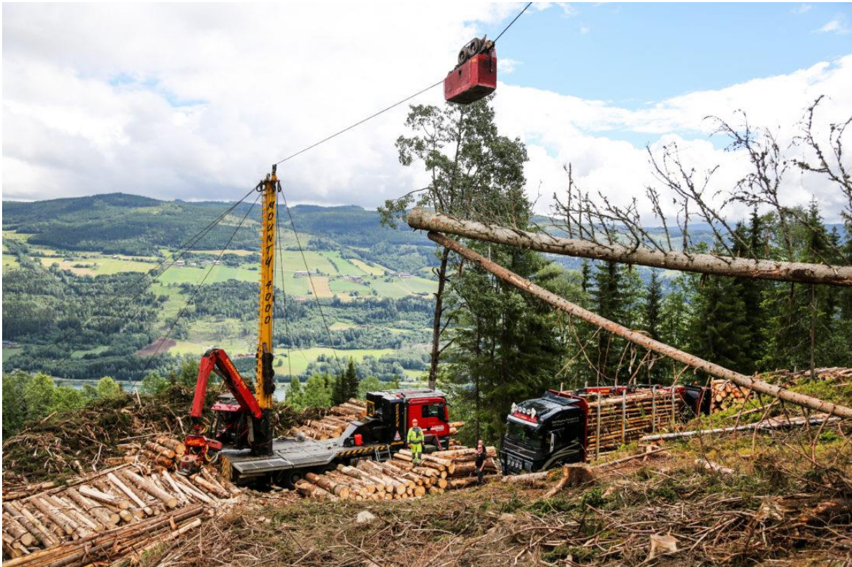
Figur 2: Bildet viser en basismaskin med kran og hogstapparat, denne maskinen frakter tømmeret med løpekatten fra terrenget og ned til lunneplass der den bruker hogstaggregat til å opparbeide tømmeret. Illustrasjonsbildet er tatt fra https://anleggsmaskinen.no/2016/08/tommerdrift-med-taubane/
