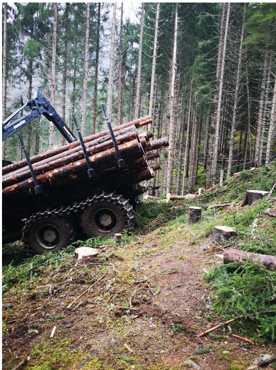
Figur7: Bildet viser en lassbærer koblet til T-winch under oppløsing av tømmer
