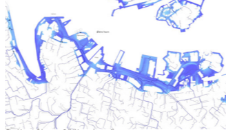
Fig. Havnivå kote 2.06 (NN2000) uten flomvern (Kartdata hentet fra Scailo Live og Norconsult 2022)
