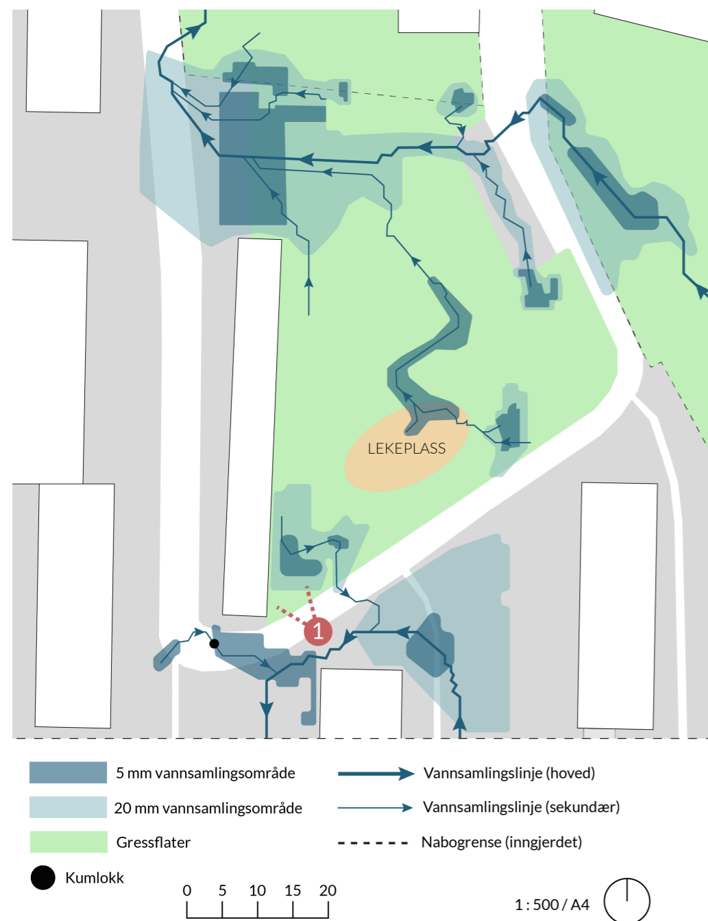
Figur 44. Kartet viser vannsamlingslinjer og retningen overvannet ledes i, og vannsamlingsområder ved forskjellige nedbørsmengder oppgitt i mm.
