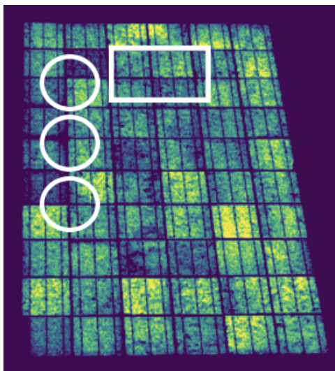
FIGURE 4.12: \Delta PL-bilde hvor område for skadepåføring er markert i hvitt.
