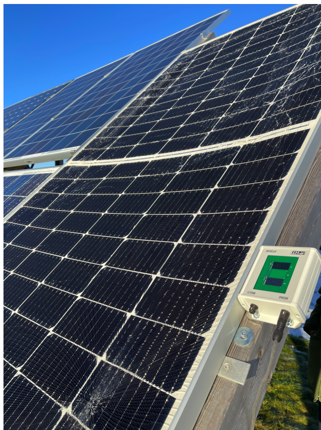
FIGURE 3.5: Referansecellen (hvit og grønn boks) festes på siden av en modul. Her er referansecellen koblet til en mono-modul.
