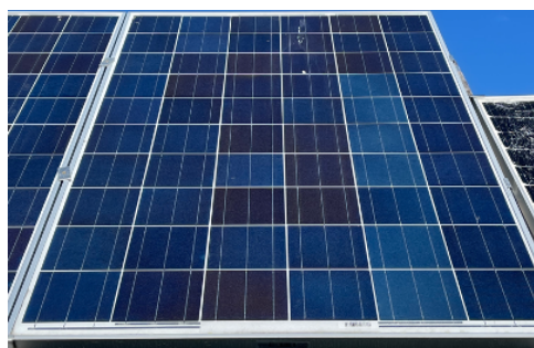
FIGURE 4.8: Visuell inspeksjon av Multi2. Støv og skit på glasset kan ikke korreleres til IV- eller PL-bilder grunnet datoen den ble utført. Ingen synlig skader på glass eller celler.
