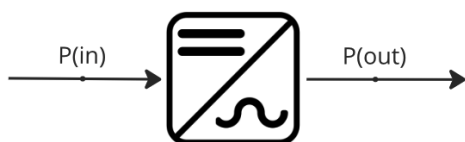
Figur 19: Elektrisitetsflyt gjennom en omformer.
