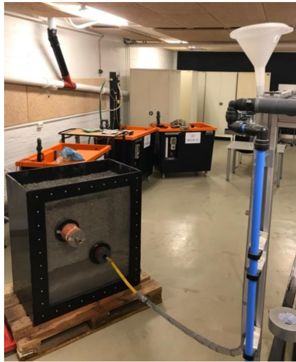
Figur 32: Bilde av tester for volumstrøm ut av lekkasjehullet på avløpsledning med fylte grøftemasser.
