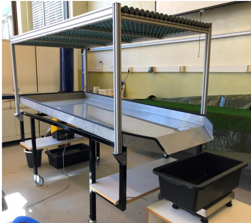
Figur 3: Bilde av nedbør-avløpssimulator (Lillevedt & Rasen, 2020).
