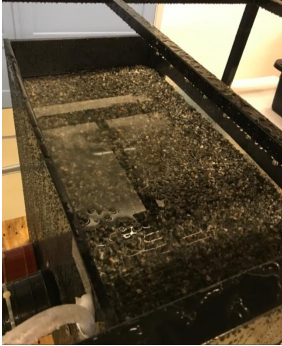
Figur 37: Bilde av mettet grøftesystem etter test for måling av tid for å få et mettet system ved en nedbørintensitet på 400 l/s*ha.
