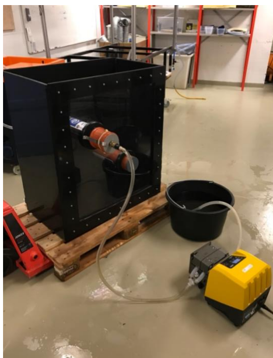
Figur 31: Bilde av testing for volumstrøm ut av lekkasjehull på drikkevannsledning ved stigende hastighet på pumpe.
