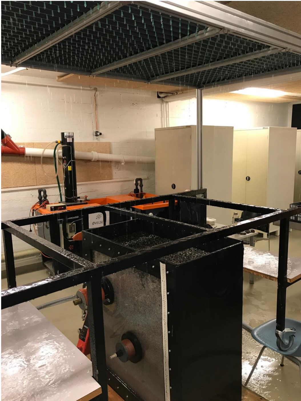
Figur 38: Oversiktsbilde av testing ved implementering av nedbør-avløpssimulator.
