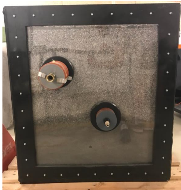
Figur 22: Ferdigstilt grøftekasse med grøftemasser sett fra innløpstversside.
