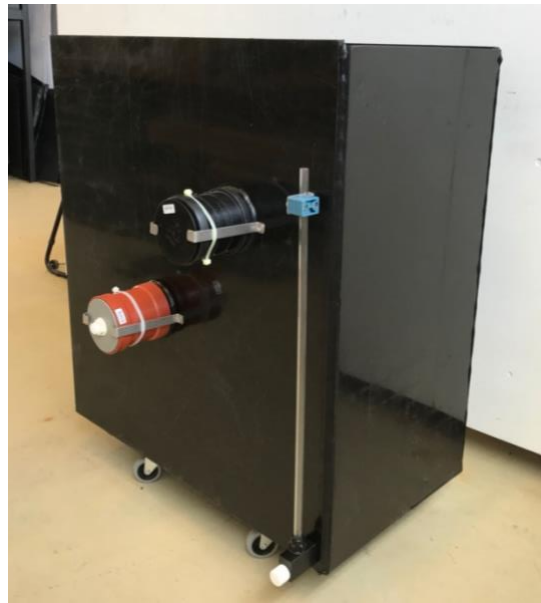
Figur 21: Ferdigstilt grøftekasse sett fra utløpstversside med tappingspunkt og stigerør.
