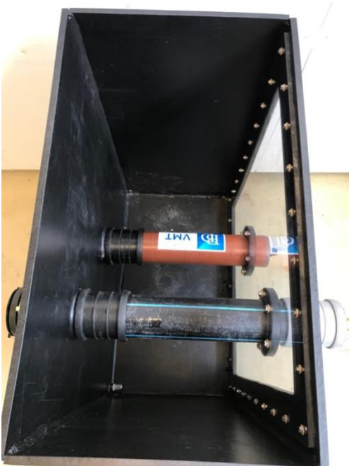
Figur 23: Ferdigstilt grøftekasse sett ovenfra uten grøftemasser.
