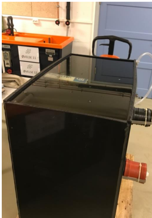
Figur 27: Bilde av tetthetstest sett fra lengdeside. Viser tydelig deformasjon i rammeverket.
