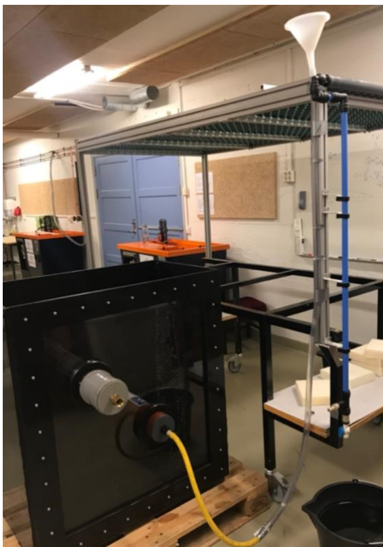
Figur 28: Bilde av testing for volumstrøm ut av lekkasjehull på avløpsledning ved ulike trykkehøyder.
