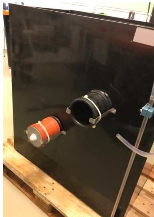
Figur 30: Bilde av utløpstverrside etter tester for pumpehastigheter på drikkevannsledning. Endestykket er trykket ut.
