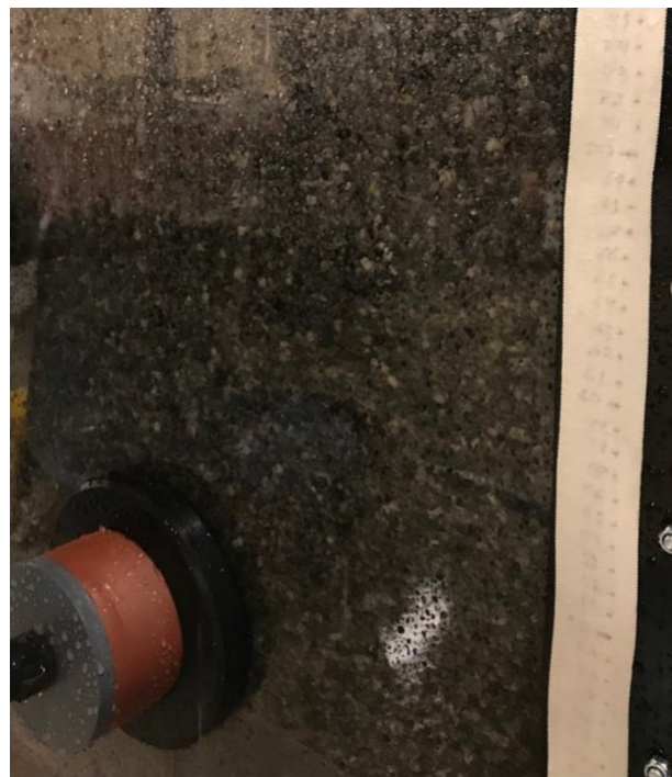
Figur 34: Bilde av grunnvannstand målt i pleksiglasset under testing med implementering av nedbør-avløpssimulator. Bildet er tatt under målt grunnvannstand på 64,5 cm i stigerøret, og 65,5 cm i pleksiglasset.
