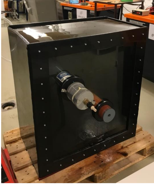
Figur 25: Bilde av tetthetstest sett fra innløpstverrside.
