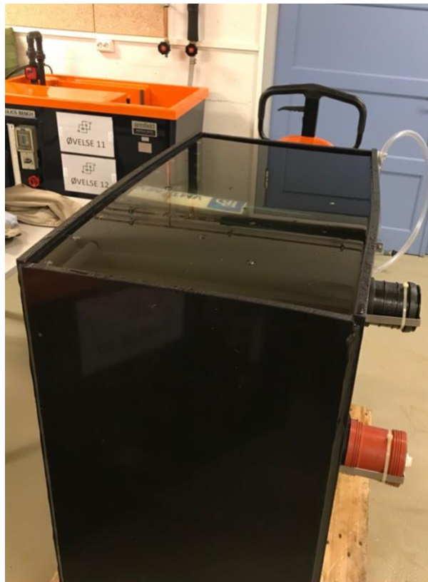
Figur 11: Bilde av tetthetstest sett fra lengdeside. Viser tydelig deformasjon i rammeverket.
