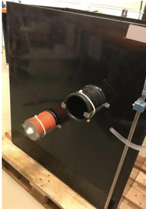
Figur 16: Bilde av utløpstverrside etter tester for volumstrøm ved ulike pumpehastigheter på drikkevannsledning. Endestykket er trykket ut.
