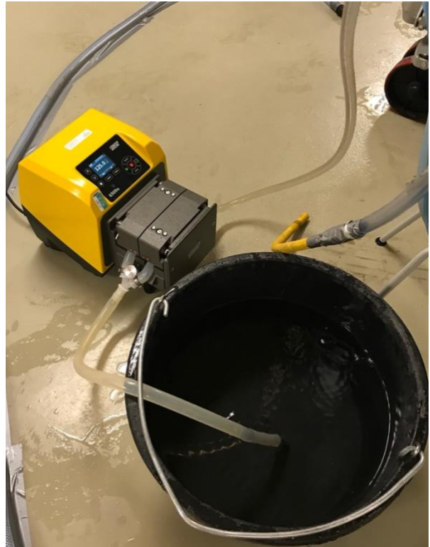
Figur 36: Bilde av pumpa som benyttes til det simulerte grøftesystemet.
