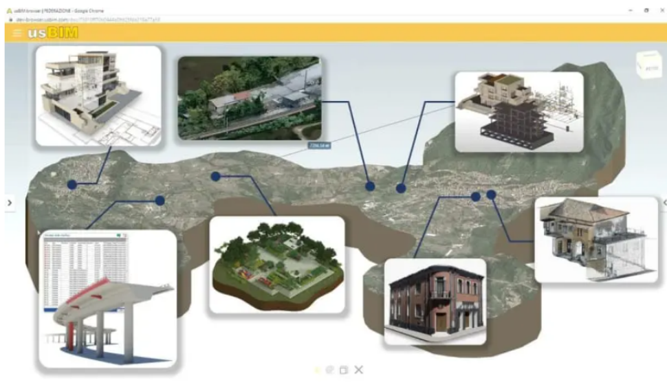
Fig. 4.3: Et eksempel på hvordan small site og large site henger sammen. Det er et stort infrastrukturprosjekt, der det er mange små prosjekter involvert. Et lite prosjekt kan trekkes ut og arbeides med uavhengig av de andre prosjektene (BibLus 2021).
