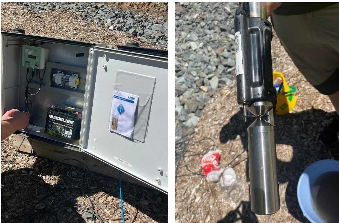
Figur 9. Bilde av skap med logger og sender (venstre). Bilde av optisk nitrat måler (høyere)(bilder, Magnus Evang).
