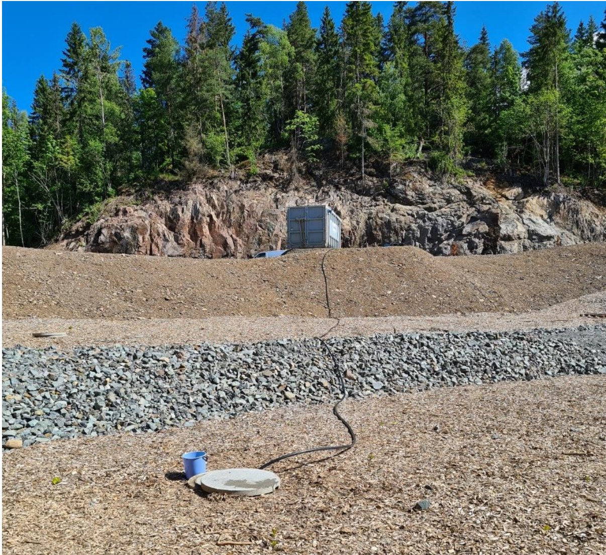
Figur 12. Bilde av konteiner fylt med tunnelvann og slange ned til F2 INN (bilde, Manh – Tien Bui)
