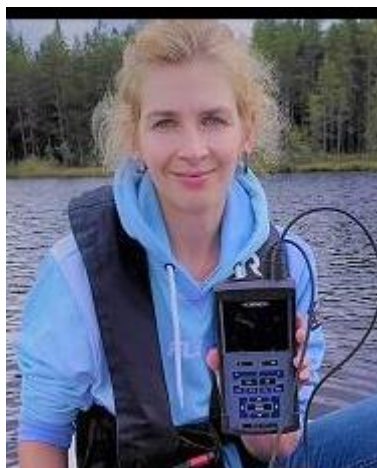
Bilde 2 (tatt av Vida Stereo). Optisk måler for oppløst oksygen, ledningsevne og temperatur.
