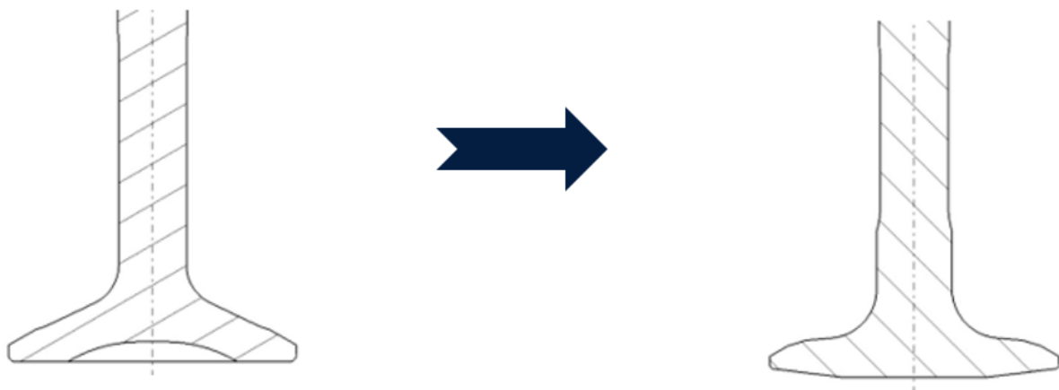
Figur 43: F.v.: Tverrsnitt av gamle diesel- og nye gass-eksosventiler (Norsk Scania AS, 2023).
