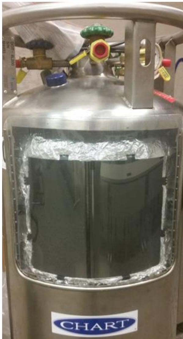
Figur 33: Tank produsert av Chart Industries, med et utsnitt som viser tankens superisolasjon (Norsk Scania AS, 2023).
