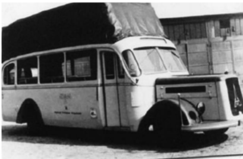
Figur 3: Offentlig buss i byen Ulm fra 1942. Tanken på taket er en lavtrykkstank med kullgass. (Basshuysen, 2016)
