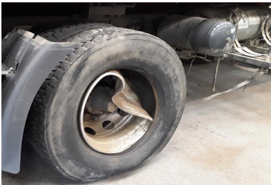
Figur 21: Ulykke i Sverige, der en CNG-tank fikk en skade og sprakk. Kreftene fra gassens ekspansjon vrengte felgen (Norsk Scania AS, 2023).
