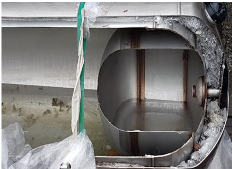
Figur 36: Bilde av ekspansjonstanken i en LNG-tank (Norsk Scania AS, 2023).
