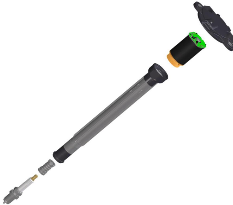
Figur 48: Illustrasjon av den nye sammensetningen av tennspole og tennplugg. Designet er laget spesielt av plasshensyn (Norsk Scania AS, 2023).
