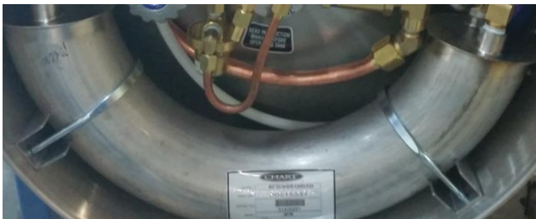
Figur 37: Bilde av den U-formede varmeveksleren på en Chart Industries tank (Norsk Scania AS, 2023).
