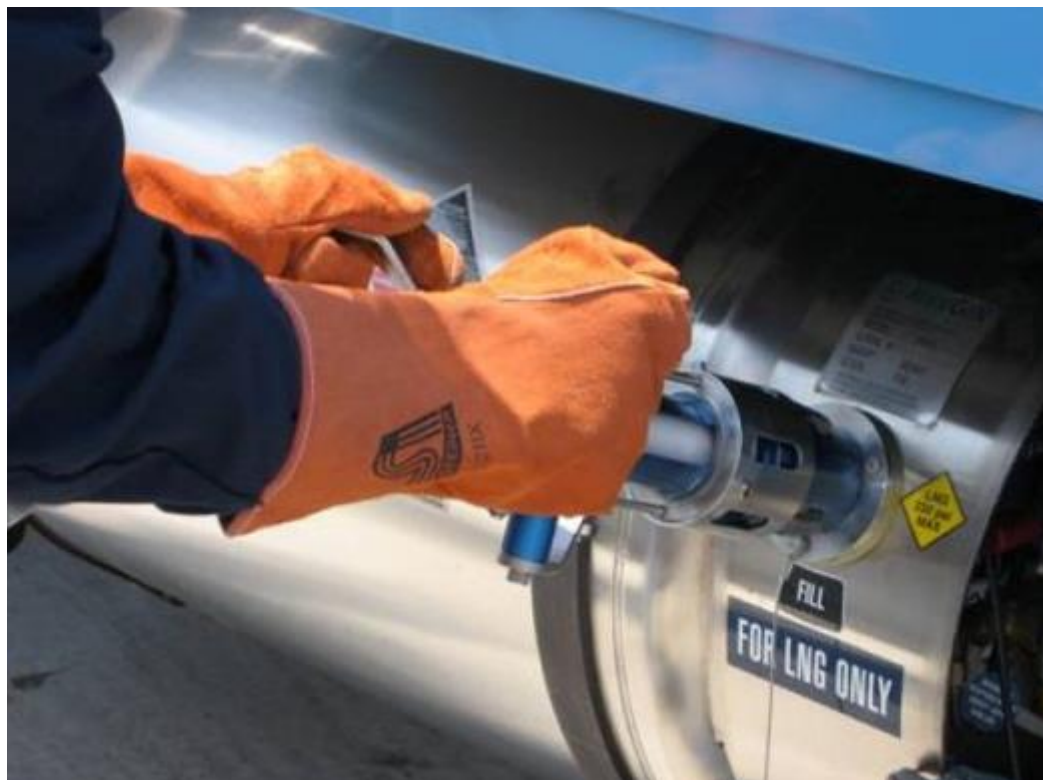
Figur 25: Fylling av et LBG-drevet kjøretøy (Norsk Scania AS, 2023).
