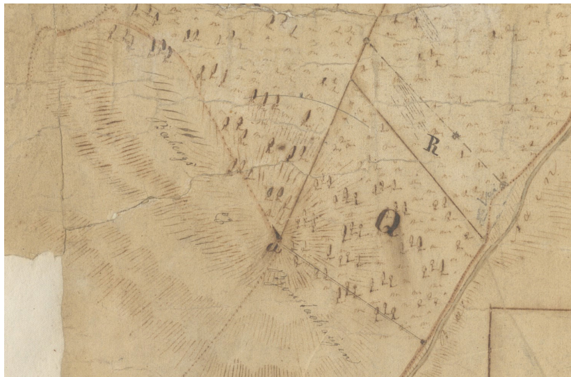
Figur 42, utklipp fra kart 53, hvor vertikale linjer illustrerer fall i terrenget
