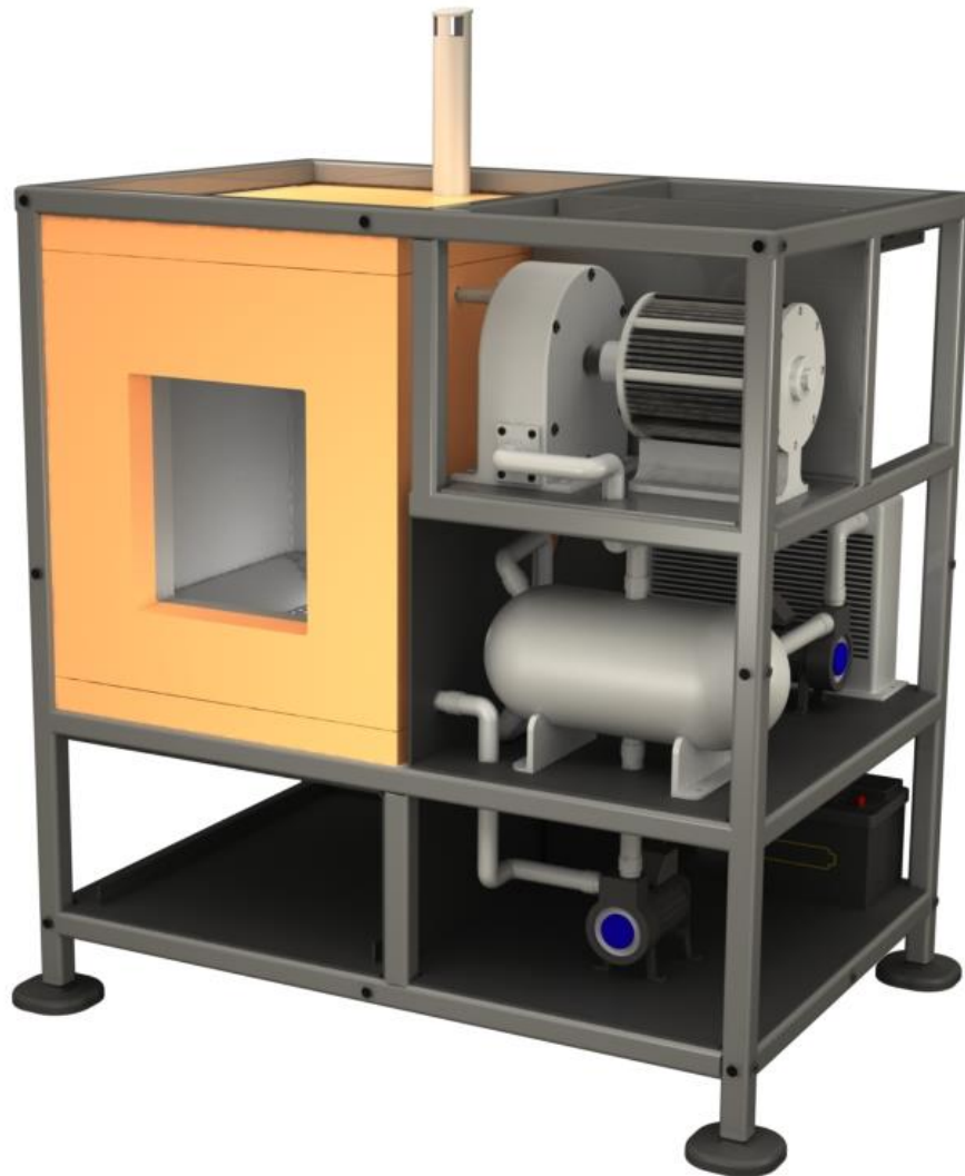
Figur 63: Illustrasjon av aluminiumrammen der komponentene i energisystemet er plassert i sine respektive rom. Dampkjelen med brannplater til venstre, dampturbin og generator øverst til høyre. Kjølesystem med kondensator, varmeveksler, vannpumpe og tilhørende rør er plassert i midten til høyre. I nederste etasje til høyre er den siste vannpumpen plassert sammen med to batterier.
