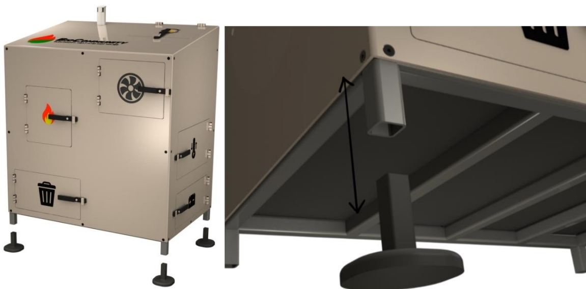
Figur 129: Montering av bein i ramme, for å sikre trygg og stabil kontakt med overflaten energisystemet står på.
