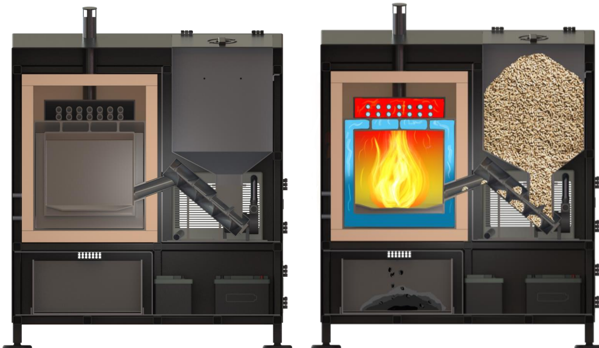
Figur 124: Illustrasjonen viser et tverrsnitt av systemet for å gi tydelig oversikt over hvordan pelletsbeholderen og matesystemet vil fungere.
