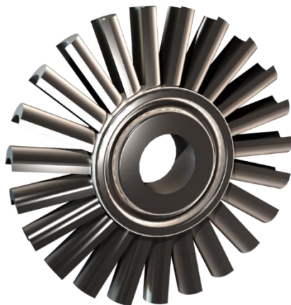
Figur 89: Illustrasjon av rotoren der den overopphetede dampen treffer turbinbladene og gjør at rotoren roterer. Rotoren har 23 turbinblad og har en ytre diameter på 200 mm.
