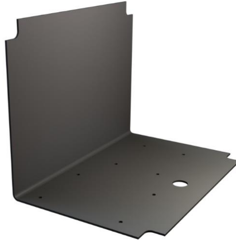
Figur 69: Illustrasjon av plate som skiller turbinrommet fra varmevekslingsrommet og matesystemet.
