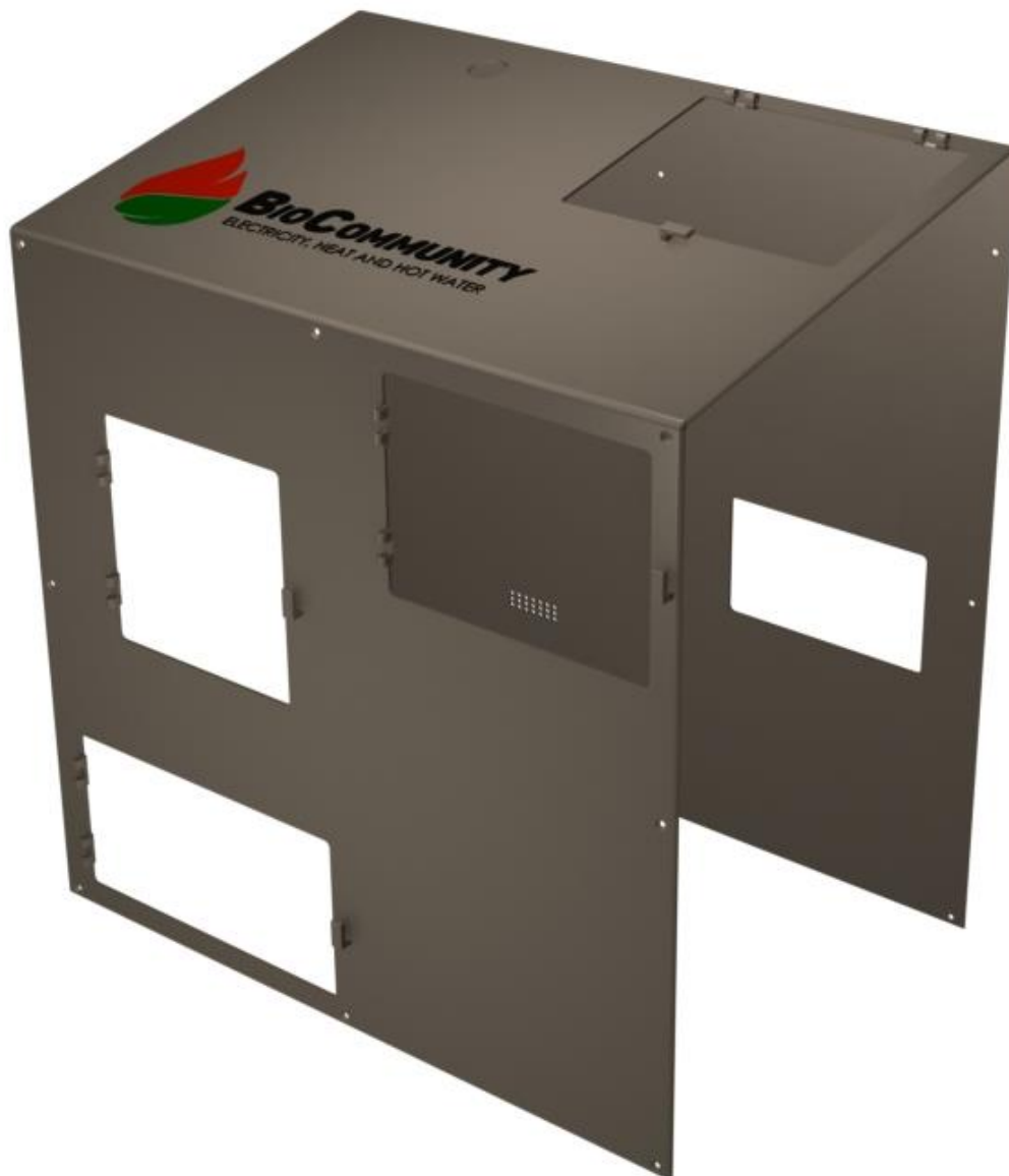
Figur 92: Illustrasjon av hovedkledningen, der det er luker til brennkammeret, askeskuffen og turbinrommet, på fremsiden av kledningen. På toppen av kledningen er det hull til pellets- og flisbeholderen. På baksiden er det hull til B6-varmeveksler (vann til luft) og hull for lufttilførselen til brennkammeret. Ved hver luke er det hengsler og låsekloss.
