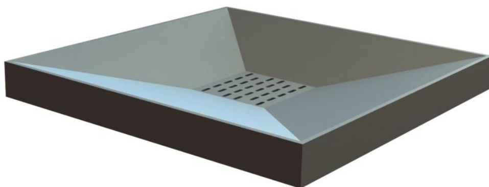
Figur 84: Illustrasjon av askebegerets utforming. Den viser de skråstilte platene som sørger for at brenselet samles i midten. Gitteret sørger for askedrenering og lufttilførsel.
