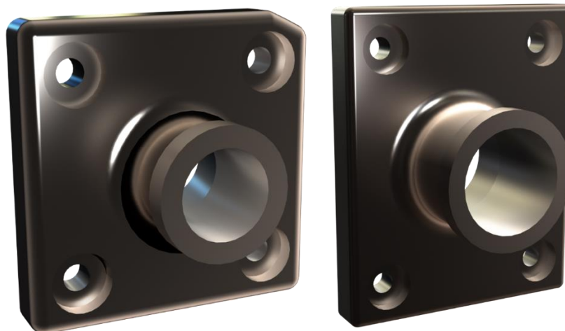
Figur 91: Venstre figur er innløpsadapteren som plasseres på baksiden av turbinhuset der damp skytes inn i turbinen. Høyre figur er utløpsadapteren som sørger et tett og sikkert utløp.
