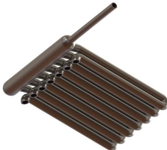
Figur 82: Figuren viser utformingen på overopphetingsenheten, der syv rør samles og fører den tørre dampen inn til dampturbinen. Innløpt av «våt» damp skjer i de syv parallelle rørene, mens utløpet av overopphetet damp skjer i røret øverst på figuren.
