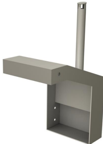
Figur 81: Figuren viser andre halvdel av dampkjelen som huser overopphetingsenheten og varmeveksleren. Hullene nede til venstre er for å føre luft inn og ut av varmeveksleren og hullet i øvre del av komponenten er for å føre overoppheteren ut av dampkjelen.
