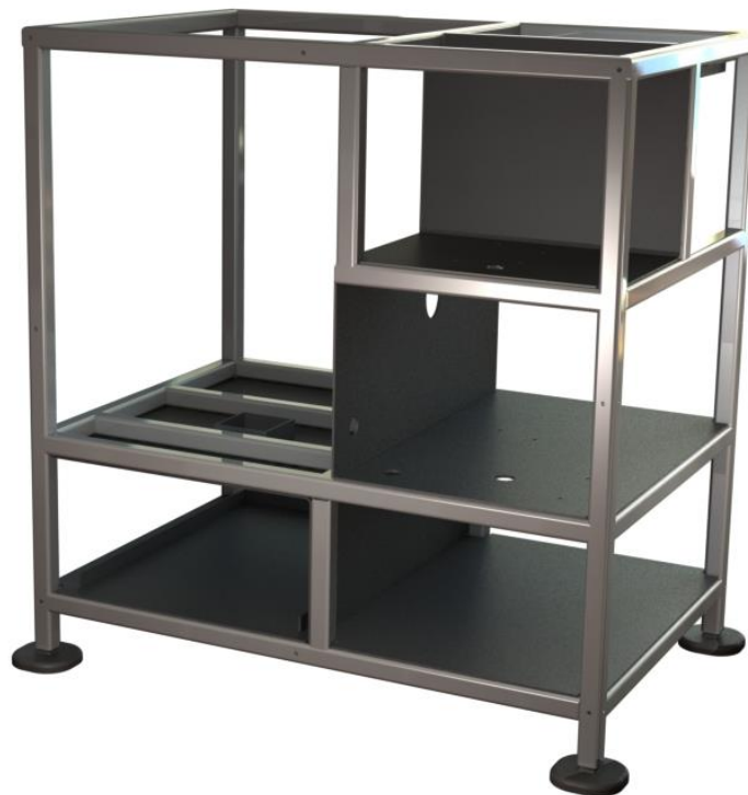
Figur 62: Illustrasjon av aluminiumrammen til systemet. Den sørger for trygg oppbevaring av alle de kritiske komponentene til energisystemet. Del-sammenstillingen består av ramme, plater, bein og har en total størrelse på 1180x780x1220 mm (LBH).
