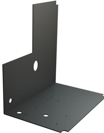
Figur 71: Illustrasjon av platen som isolerer varmevekslingsrommet fra resten av systemet. Platen har hull til rør, bolter og matesystem.
