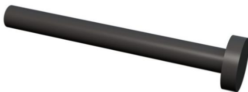
Figur 101: Illustrasjon av låsesplinten, som fester dørene til kledningen.
