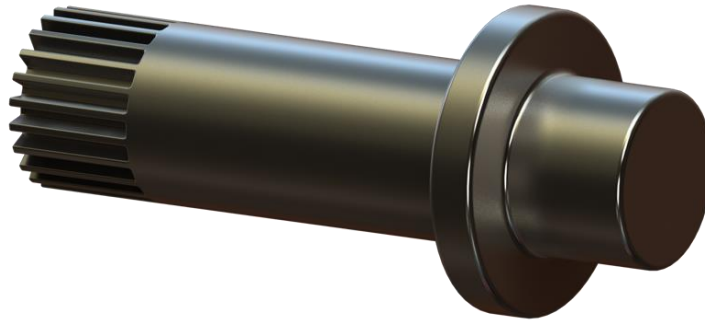
Figur 90: Illustrasjonen viser akslingen til turbinen. Den sørger for at rotoren kan overføre de roterende kreftene til generatoren, ved hjelp av 21 splines. Antall splines tilfredsstiller kravet for høye rotasjonshastigheter.
