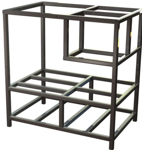
Figur 67: Illustrasjon av rammen til energisystemet, som er kjernen i del-sammenstillingen.
