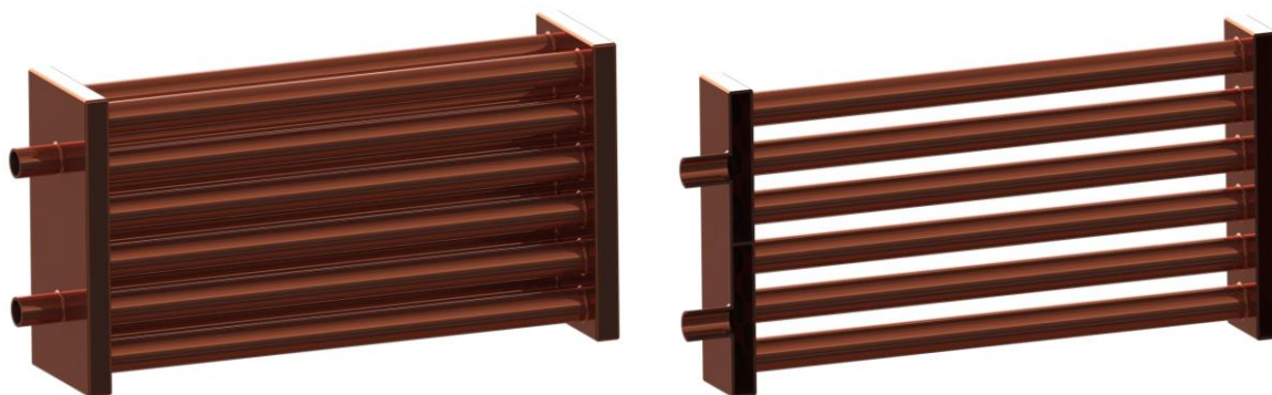
Figur 83: Figuren viser varmeveksleren med gjennomskjæring til høyre. Innløp er øverst på modellen og utløp er nederst. Varmeveksleren kan benyttes til å varme fritidsboligen.
