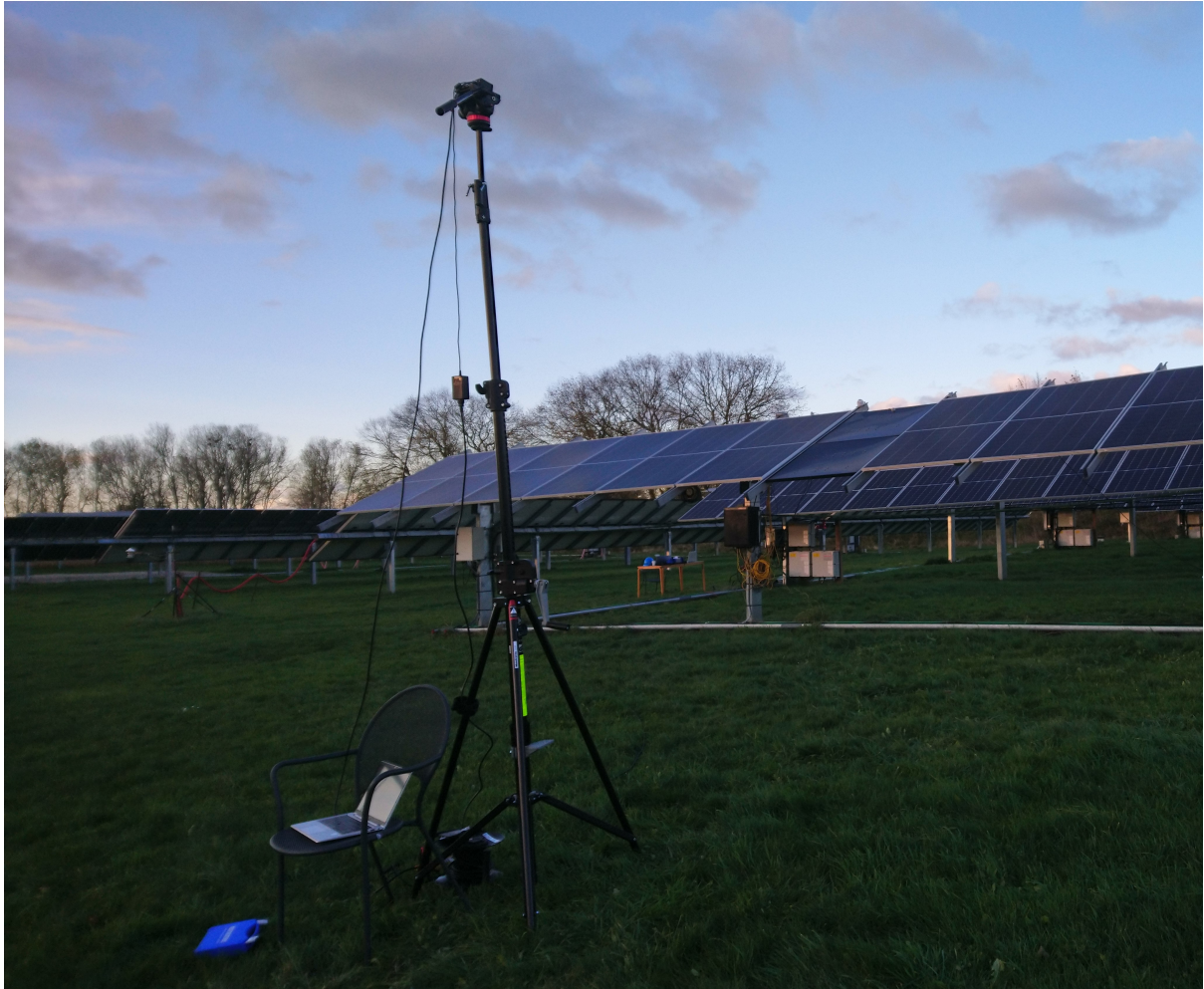
Figur A.1: Bilde fra solcelleanlegget, som viser oppsettet for PL-avbildningen. Merk at bildet ble tatt etter at dataene var ferdig innsamlet og været var blitt noe mer overskyet.
