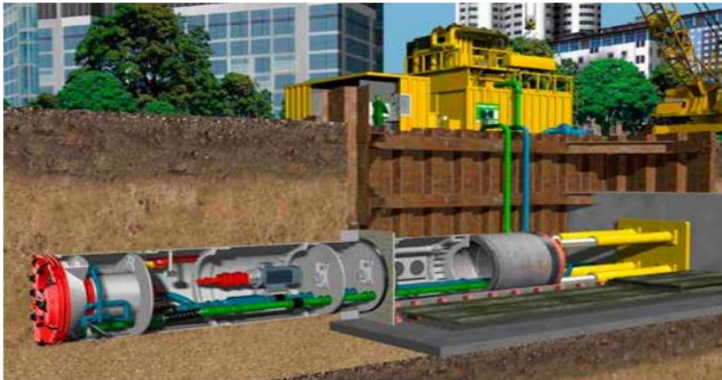
Figur 4: En grøftfri forbindelse Startrøret er et spesialkonstruert rør i stål, og inneholder alt av nødvendig utstyr (Hofshagen, ABCf or gravefri framtid, 2018, s. 94)
