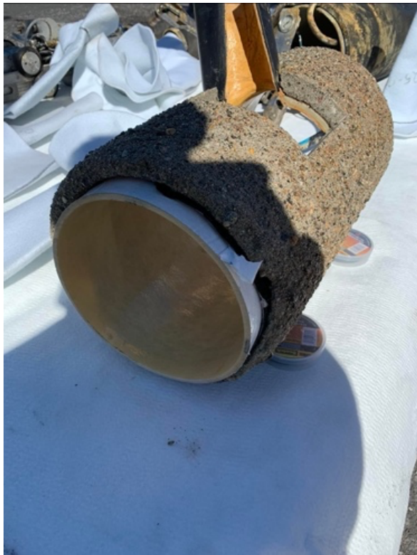
Figur 36: Strømperenovering av betongledning. Bilde tatt under åpen dag hos Olimb AS.
