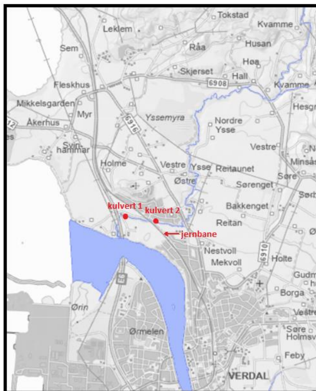
Figur 12. Kartet viser Ysseelvas plassering samt utløp i Verdalselvas deltaområde. Røde punkt markerer kulvertene, der kulvert 1 var del av byggefase 1 med erosjonssikring mellom kulvert 1 og 2, og veikryssing med kulvert 2 oppstrøms jernbanen var byggefase 2 (Miljødirektoratet, u.å)
