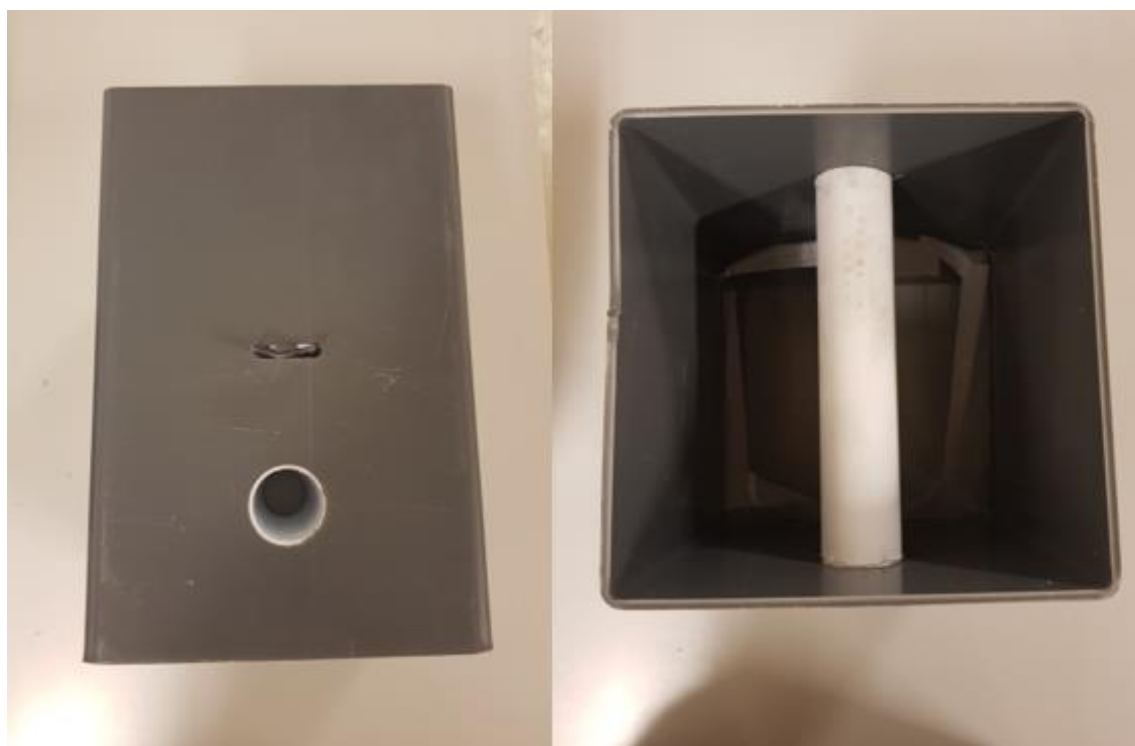
Figur B.1: Detaljbilder av utløpet fra bygninger med og uten trakt.
