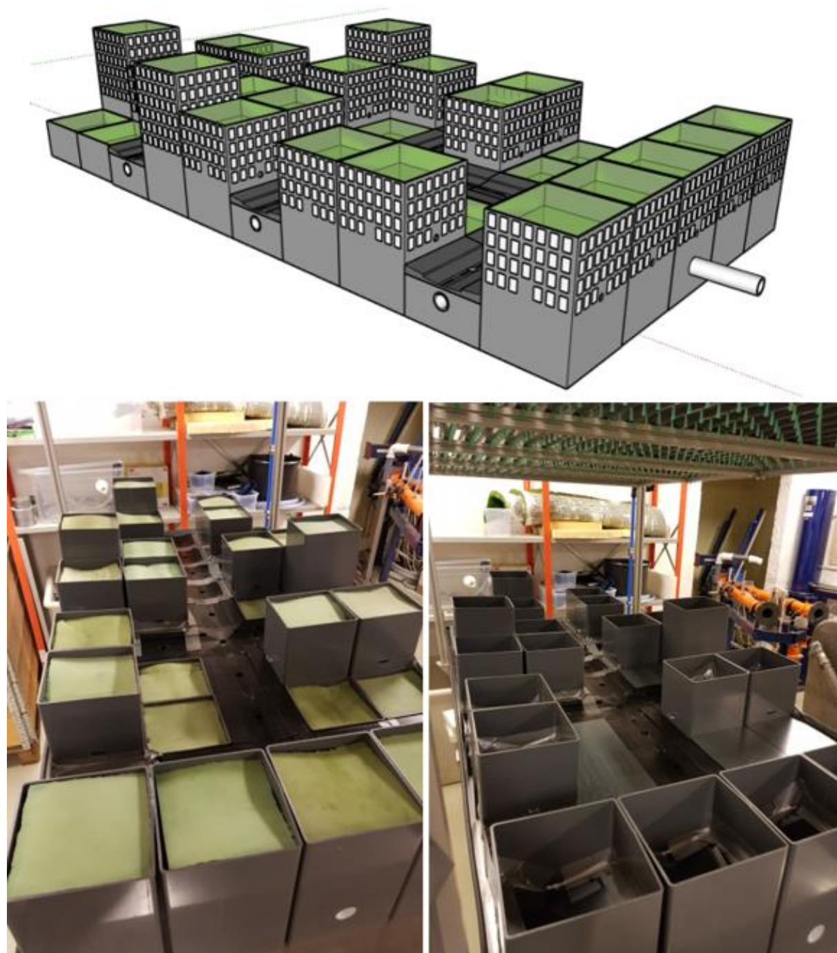
Figur 13: Illustrasjon av ferdig modellby i SketchUp (øverst). Fysisk modellby slik den ble seende ut med tiltak (venstre) og slik den ble seende ut uten tiltak (høyre).
