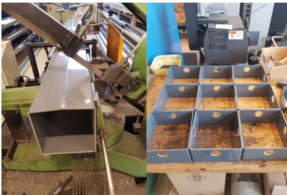
Figur 14: Firkant-PVC rørene. Til venstre klare for kutting og til høyre er gatemodulene ferdigstilt og klare for montering av rør og 3D-printet gateoverflate.
