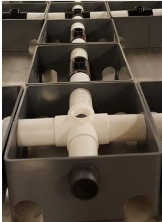
Figur 18: Nærbilde av rørsystemet for å tydeliggjøre hvordan vannet transporteres fra en modul til neste.
