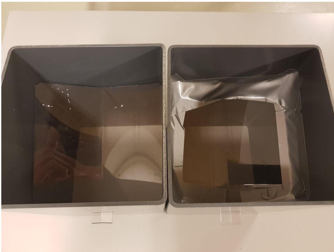
Figur B.3: Byggene med trakt sett ovenfra, før og etter tetting med gaffateip.
