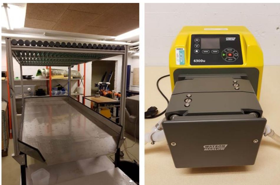
Figur 8: Nedbørsimulatoren til venstre og pumpen som forsyner systemet med vann til høyre.
