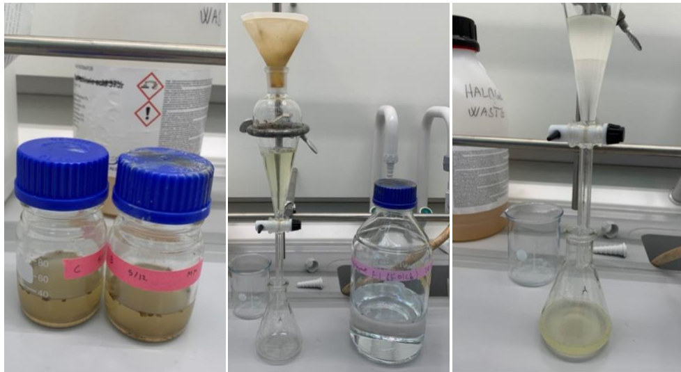
Figur 8: Viser oppsett for lipidekstraksjon og tre prøver: to i pyrex flaske som venter på ekstraksjon og en allerede i skilletrakt. Samme oppsett ble brukt for ekstraksjon av lipidene i alle prøvene.
