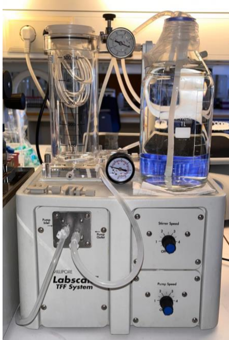
Figur 5. Ultrafiltreringsanlegg brukt under studien.
