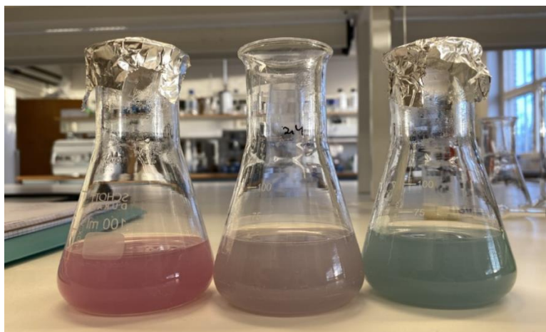
Figur 7. Illustrasjonsbilde som viser fiolett/rosa farge før titrering (t.v.), fiolett/blå farge underveis i titrering og blå farge ved endelig fargeomslag (t.h.).
