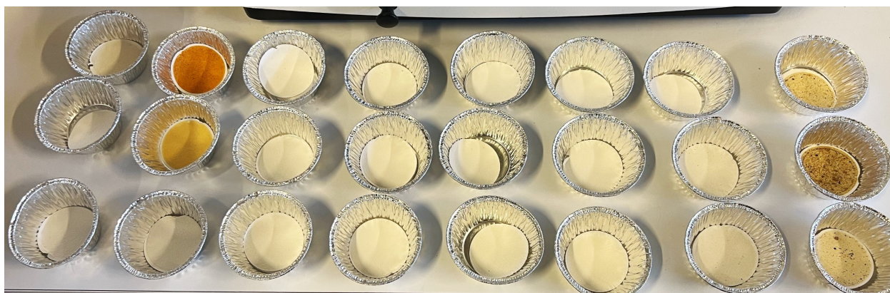
Bilde 3-1 Viser tørkede SS-prøver. Nederst 7.januar, midten 9.januar, øverst 11.januar. Alle radene er plassert i rekkefølge fra venstre; MAP1, MAP2, BC1, BC2, C1, C2, BAF, GW
