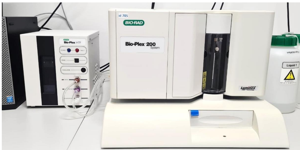
Figur 2-6 Avlesningsinstrument benyttet for kulebasert multipleks cytokinanalyse. Bio-Plex™ 200 System og Bio-Plex™ HTF (Bio-Rad). Foto: Tuva Løken Frøvoll
