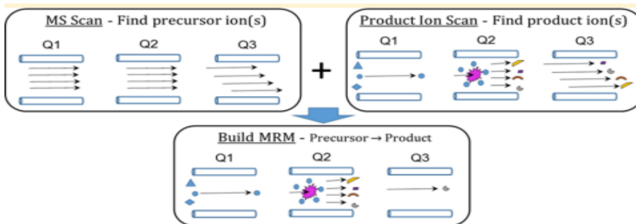
Figur 2-9-1: Gir en illustrasjon av de tre mulighetene ved et trippel kvadrupolsystem som ble benyttet i dette forsøket (Betts et al., 2018).
