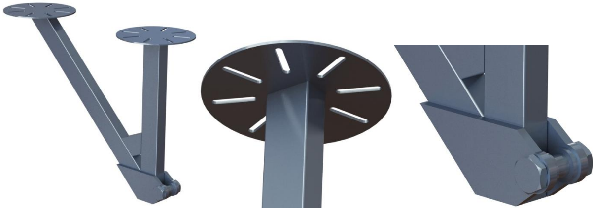
Figur 11.2 Viser hovedelementene i konstruksjonen under flytebryggen, med et detaljert bilde for festeplaten på toppen for flytebryggen og festet til stempelet.
