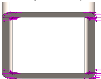
Figur 9.2 Viser kraften på bunnen av bjelken.
