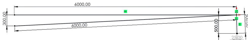
Figur 8.8 Verifisering av slagende på 25 mm på SolidWorks
