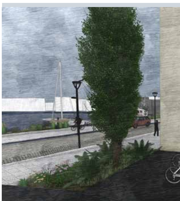
Ved Skansetorget er det anlagt regnbed for håndtering og fordrøyning av overvann
