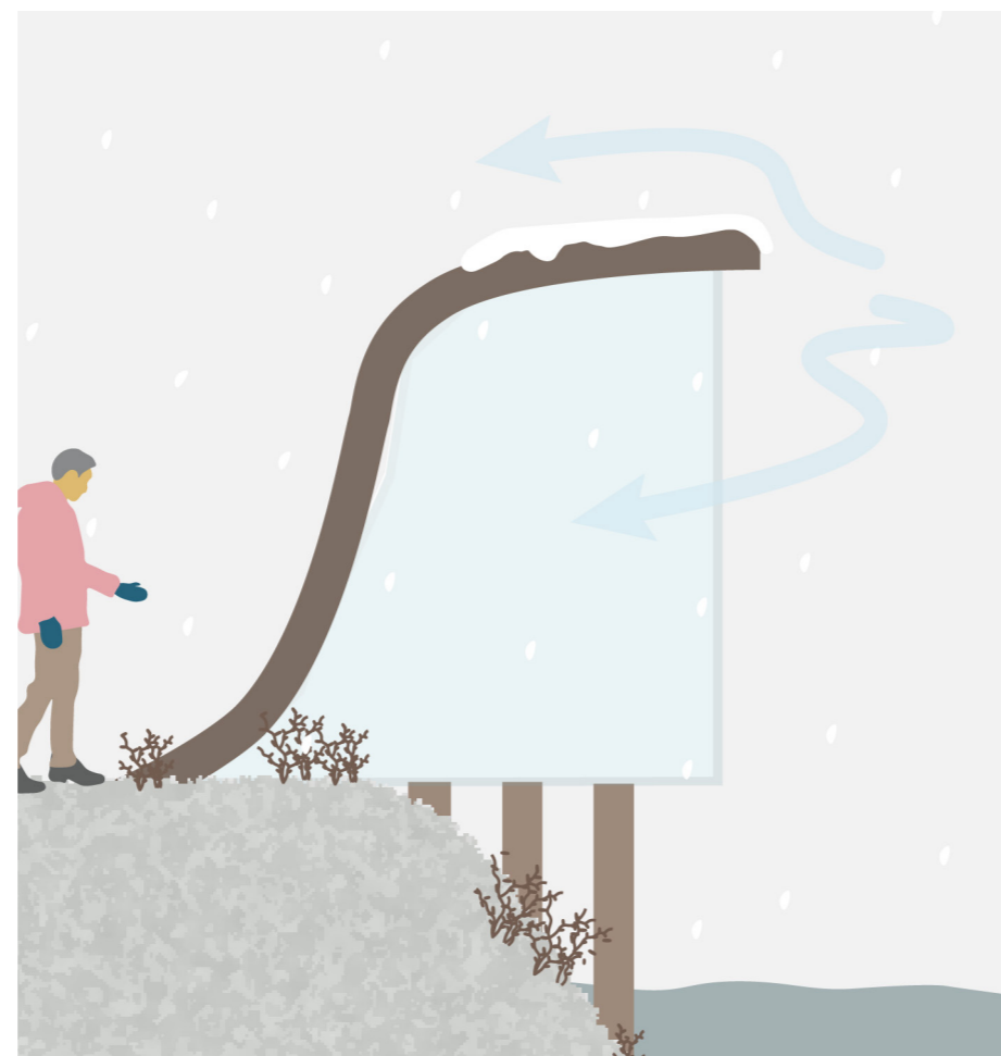
Figur 4.23. Varmehytte på påler i Glomma som beskytter mot vinden og slipper sollyset igjennom glassfasaden
