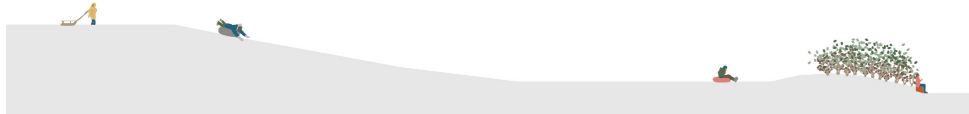
Figur 4.13. Prinsippnitt av akebakken viser hvordan den er tenkt med en liten voll nederst i bakken for å stoppe de akende. I vollen er det en sittebenk på sørsiden
