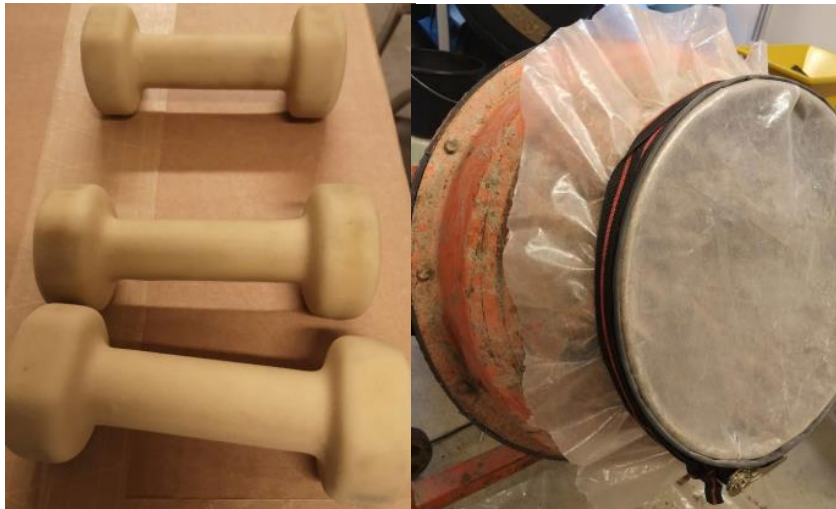
Figur 7: Frysetørka A. taxiformis blei knust ved hjelp av tre 1 kg manualar rotert rundt i ein sementblander. Foto: Privat
