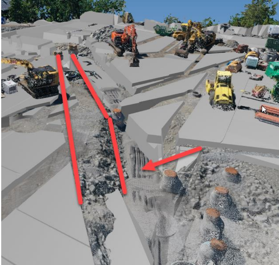
Figur 27 -Rør plassert annerledes fra originalt tiltenkt plassering – Hentet fra Nye Fjerdingby skole BIMcollab Zoom
