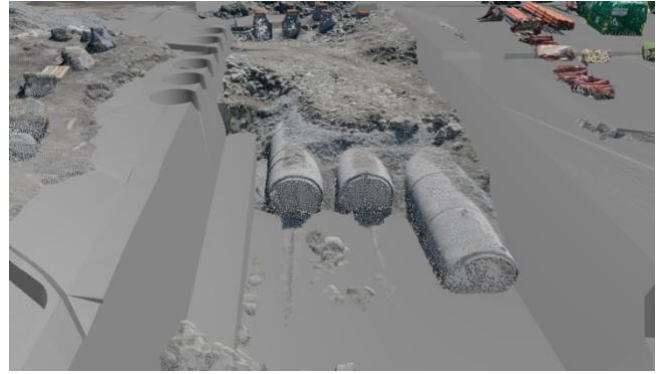
Figur 23 - Terreng etter graving og plassering av overvannsledning – Hentet fra BIMcollab Zoom
