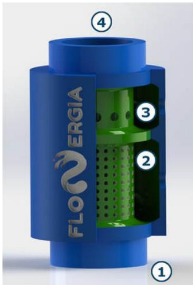
Figur 3. Kommersielt mammutpumpeprodukt fra FloNergia Inc (FloNergia). Bildet viser komponenten hvor luften blir introdusert både radielt (2) og aksielt (3), såkalt dual injection. Videre er (1) Innløpet og (4) utløpet.
