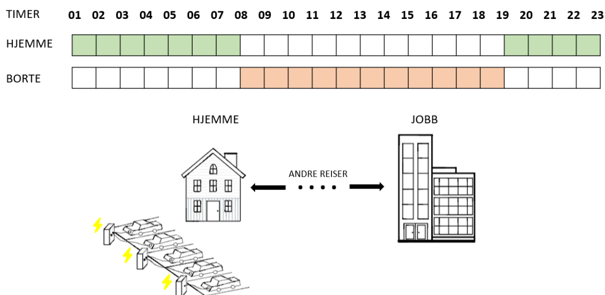
Figur 4.5: Forklaring av reise og opphold for en tilfeldig elbil. Elbilen vil reise fra boligfeltet kl 08:00 og være tilbake kl 19:00. I denne perioden vil elbilen kjøre sin daglige kjørelengde. Elbilen kan dermed kun lade i tidsintervallet kl 19:00 til kl 07:59.
