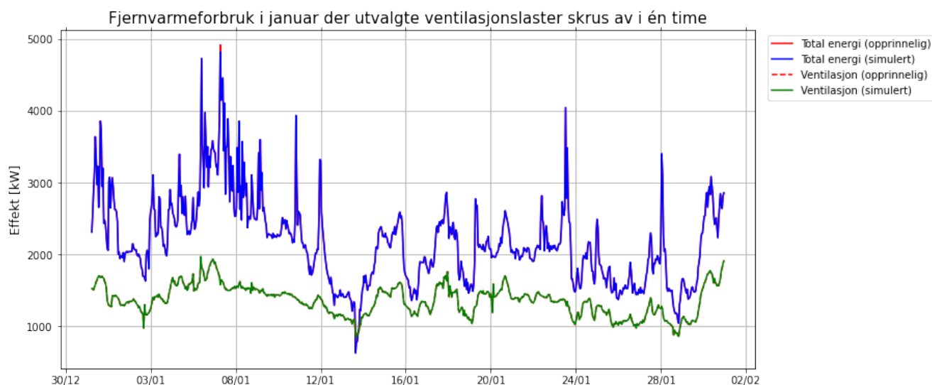
Figur A.2.2: Den blå grafen viser energiforbruket dersom ventilasjonslaster i januar skrus helt av. De røde grafene viser det opprinnelige forbruket, og den grønne grafen viser det nye energiforbruket til ventilasjonen når den reduseres ved effekttopper.
