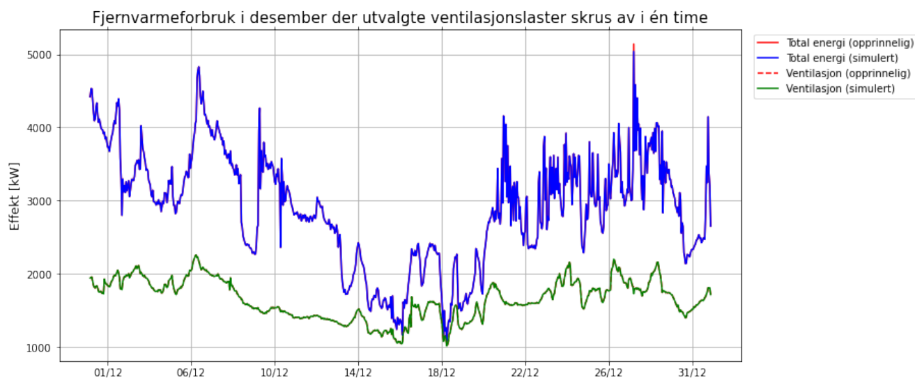
Figur A.2.1: Den blå grafen viser energiforbruket dersom utvalgte ventilasjonslaster i desember skrus helt av. De røde grafene viser det opprinnelige forbruket, og illustrerer dermed hvordan effekttopper blir redusert. Den grønne grafen viser det nye energiforbruket til ventilasjonen når den reduseres ved effekttopper.
